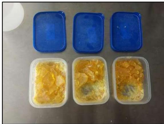
**Figura 12.** Brea cristalizada, obtenida por destilación
