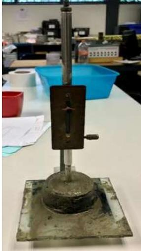
Figura 16. Determinación de consistencia normal en mezclas de cemento en aparato Vicat.
