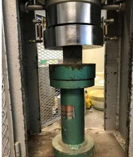
Figura 19. Máquina para ensayos de compresión ELVEC.
