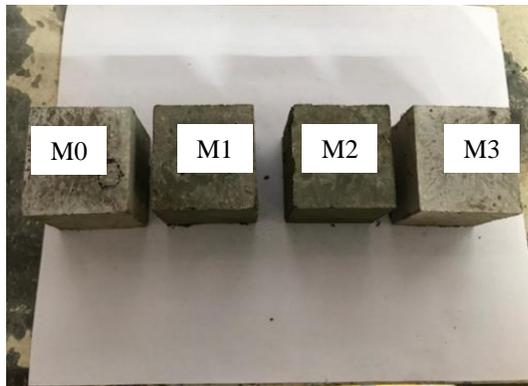
Figura 17. Elaboración de cubos de mortero, M0 mezcla sin aditivo, las mezclas que contienen el aditivo retardante (M1, M2 y M3).
