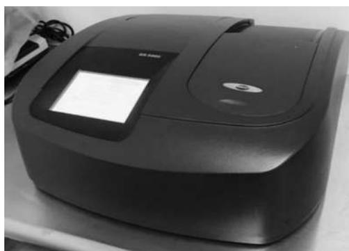
Figura 11. Espectrofotómetro UV-VIS DR 5000, empleado en las mediciones de este proyecto.
