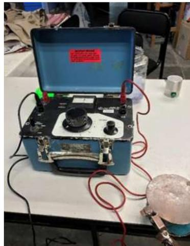
Figura 20. Medidor SOIL 400 de Resistividad Eléctrica Húmeda
