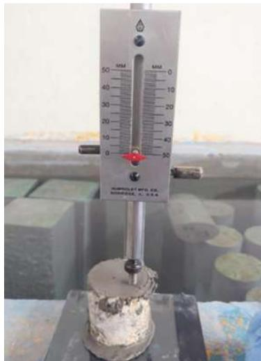
Figura 13. Pruebas de tiempos de fraguado en mezclas de cemento aparato Vicat.
