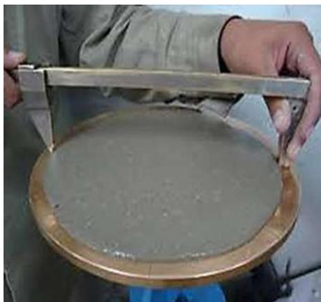
Figura 15. Medición de la fluidez en morteros. Tomada de NMX-C-486-0NNCCE-2014.
