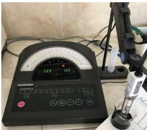
Figura 7. Medidor de pH HORIBA M-12.
