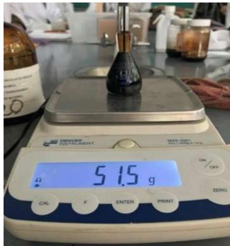
Figura 9. Picnómetro con la muestra de aditivo.
