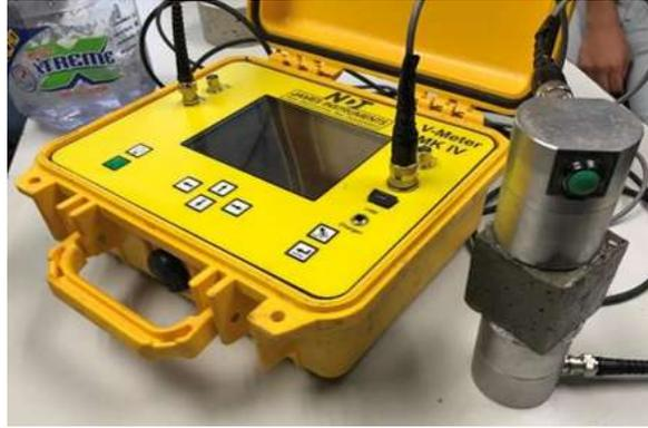
Figura 21. V-Meter MK IV prueba de Velocidad de Pulso Ultrasónico en cubos de mortero.
