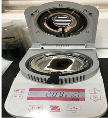
Figura 8. Balanza termogravimétrica OHAUS MB-23.
