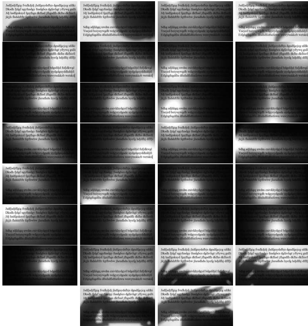
Figura 4.3: Imágenes con iluminación no uniforme generada a partir de iluminación real
