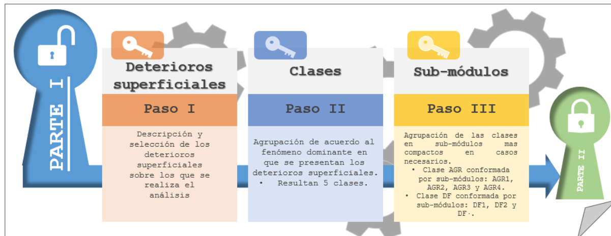
Figura 4.9: Parte I. Agrupamiento de los deterioros superficiales.
