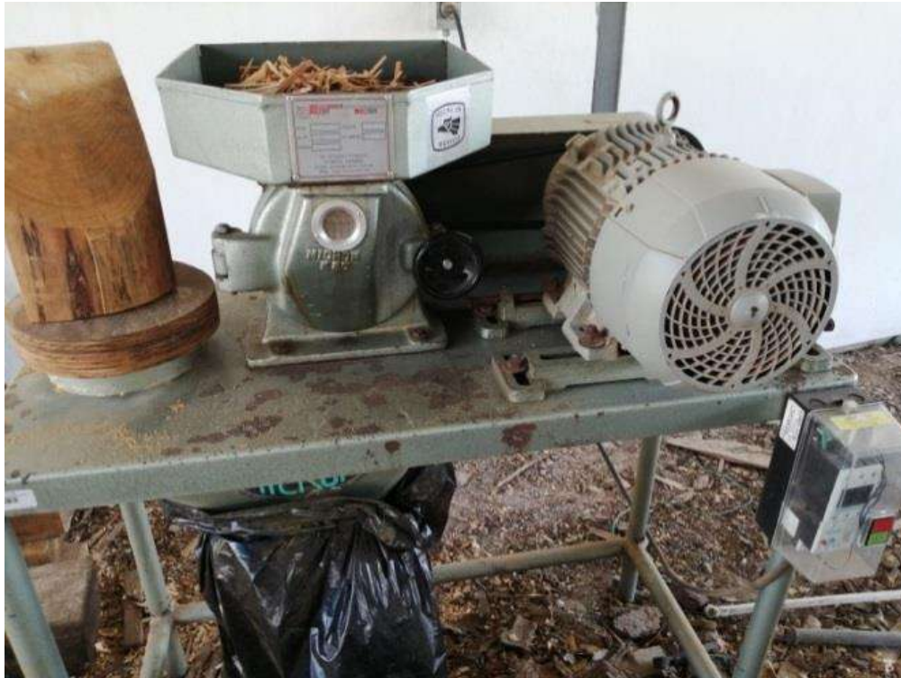
Figura 4. Esta imagen muestra el equipo utilizado para la molienda, en la parte superior se encuentra las astillas de la teca y debajo de la plataforma del aparato fue colocada una bolsa para recolectar la madera hecha harina.
