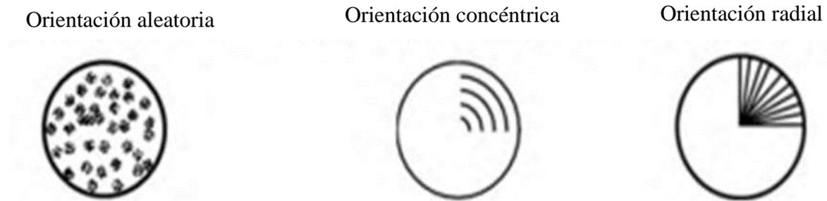
**Figura 7** Esquema de las orientaciones radiales, concéntricas y aleatorias de las capas de esferas de carbono [55]
