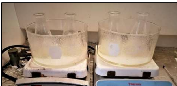
Figura 3.6. Baño maría de las muestras para la determinación de holocelulosa.
