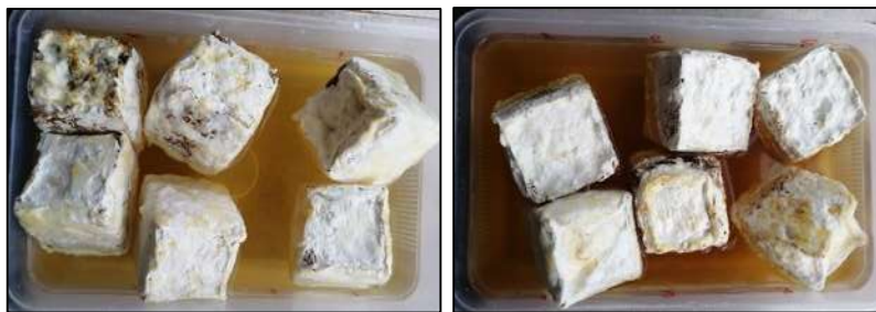
Figura 3.15. Inmersión de los bioplásticos en recipientes con agua destilada.
