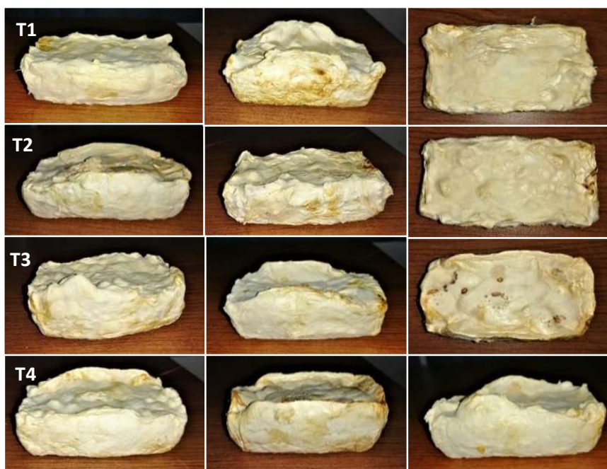
Figura 4.1. Bioplásticos obtenidos de los diferentes tratamientos colonizados con P. ostretaus . T1: astillas-micelio, T2: astillas/olote-micelio, T3: aserrín-micelio, T4: aserrín/olote-micelio.
