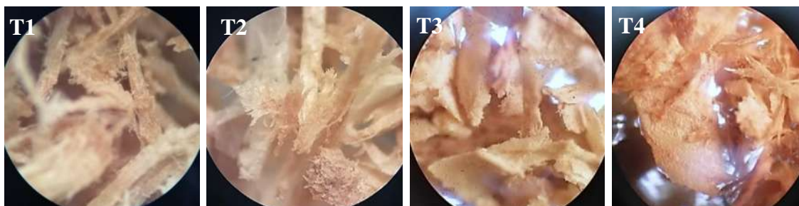
Figura 4.3. Imágenes topográficas realizadas en microscopia óptica a 80x de los tratamientos control. T1: astillas, T2: astillas-olote, T3: aserrín, T4: aserrín-olote.
