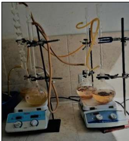
Figura 3.7. Sistema de reflujo para la determinación de lignina.
