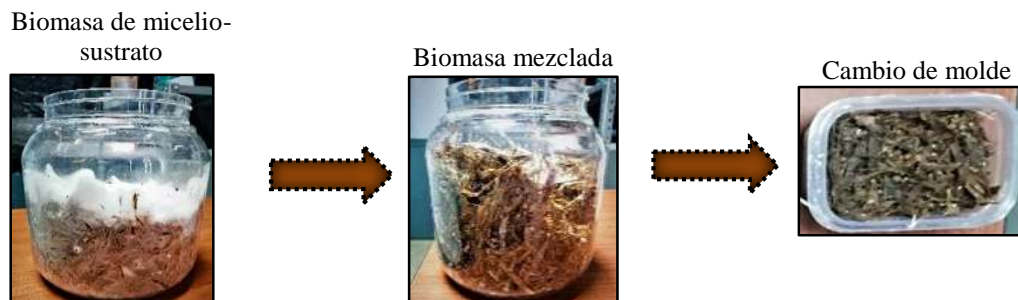
Figura 3.10. Remoción de sustrato y cambio de molde.
