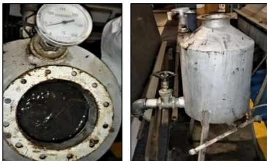
Figura 3.8. Pasteurización de sustratos en tanque de calentamiento presurizado.
