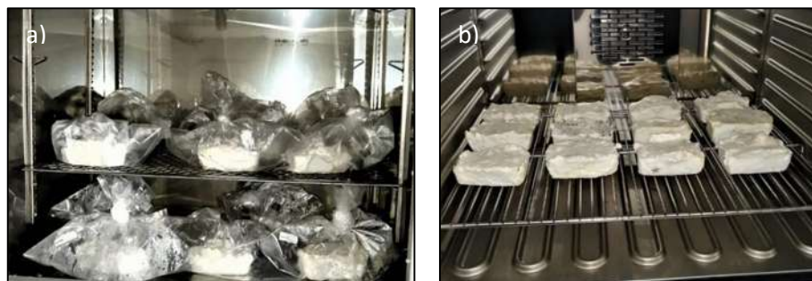
Figura 3.11. a) desarrollo de biomasa de micelio en bolsas, b) inhibición del hongo y eliminación de exceso de humedad.
