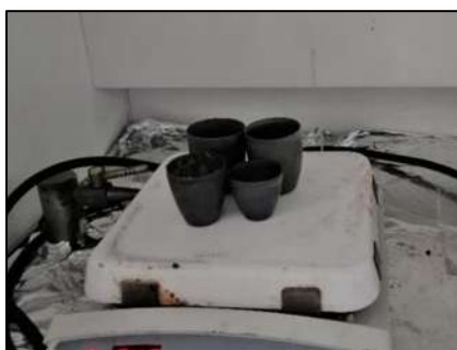
Figura 3.5. Calcinación de las muestras en placa de calentamiento para la determinación de cenizas.
