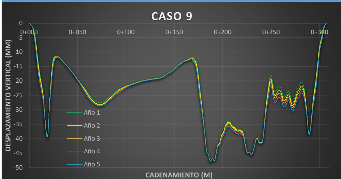
Figura 47 Evolución del perfil para el caso 9, con esfuerzo aplicado de 0.35 MPa.
