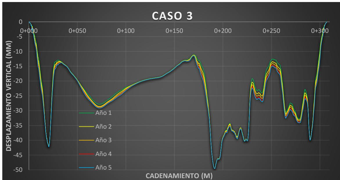
Figura 41 Evolución del perfil para el caso 3, con esfuerzo aplicado de 0.35 MPa.
