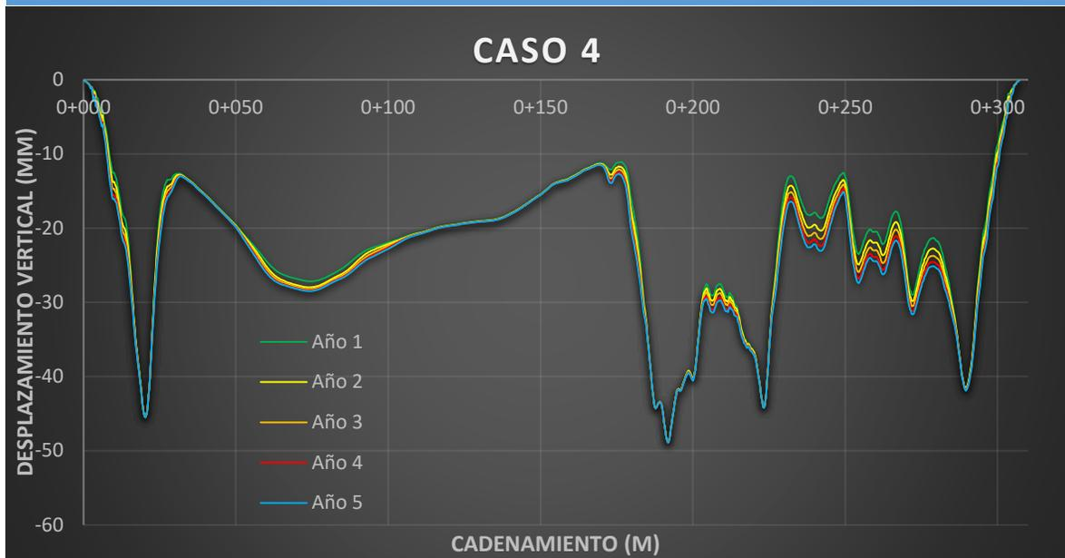
Figura 42 Evolución del perfil para el caso 4, con esfuerzo aplicado de 0.35 MPa.
