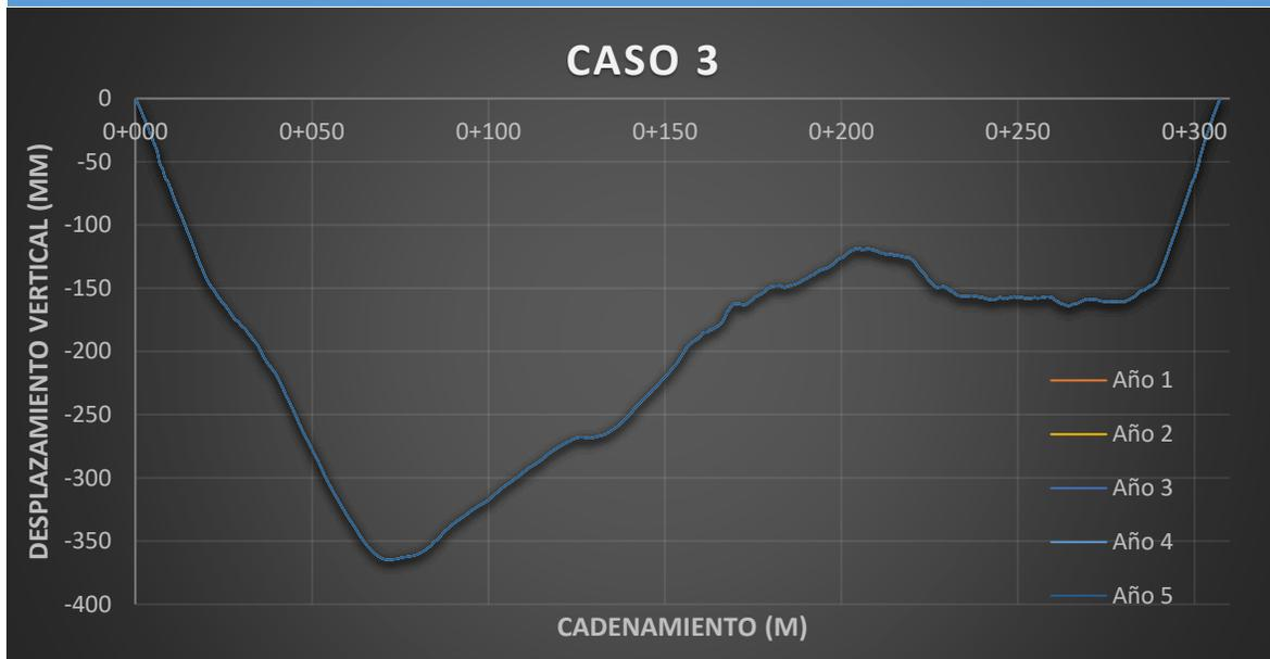
Figura 66 Evolución del perfil para el caso 3, con esfuerzo aplicado de 0.569 MPa.
