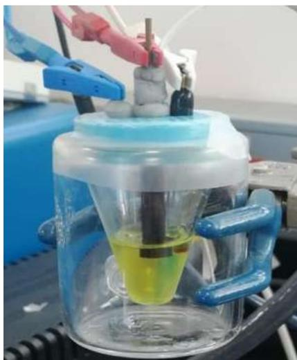
**Figura 10.** Celda electroquímica de vidrio con arreglo de tres electrodos inmersos en la solución de la molécula sonda. En la parte superior de la celda se encuentra el tapón de teflón con entradas para los electrodos mismos que se encuentran conectados al potenciostato a través de caimanes eléctricos (rojo-Tra, azul-Aux, blanco-Ref).
