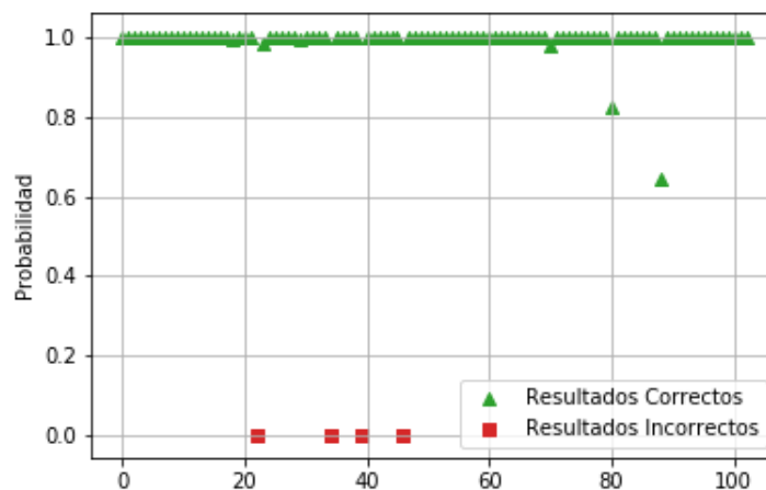
Figura 4.4: Predicción del modelo en los datos del conjunto de prueba para la clasificación gamma-hadrón. Los triángulos verdes representan los ejemplos clasificados correctamente, los cuadros rojos representan los ejemplos clasificados incorrectamente. El eje vertical representa la probabilidad que da como salida la RNC, para la categoría correcta de cada ejemplo.
