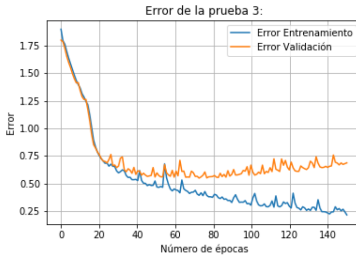
Figura 4.10: Evolución del error de entrenamiento y validación para la prueba 3. La línea azul representa el error de entrenamiento, la línea naranja representa el error de validación. El valor mínimo del error de validación se encontró en la época 73 del proceso de aprendizaje.
