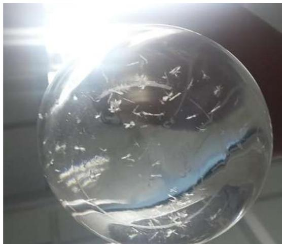
Figura 21: Cristales de rebaudiósido A en la prueba de saturación a 15 % de sólidos
