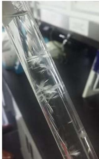
Figura 25: Cristales de rebaudiósido A en la prueba de saturación a 56 % de sólidos
