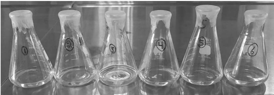
Figura 22: Muestras en etapa inicial de cristalización de rebaudiósido A en prueba de saturación a 56 % de sólidos
