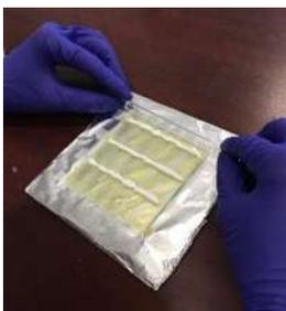
Se colocó la segunda capa de titania (pasta amarilla) después se llevó a la plancha con una temperatura de  $100\text{ }^\circ\text{C}$  y se dejó por 10 min. En seguida se colocó la siguiente capa (pasta blanca) y se hizo el mismo procedimiento. Se sometieron a calcinación en la mufla con la programación de temperatura ya descrita anteriormente.
