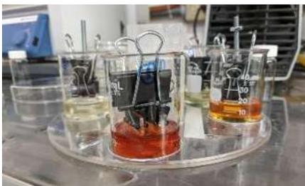
Posteriormente se depositaron por separado los pigmentos (1-5) por el método de dispersión en concentraciones de  $0.7\text{ mg/mL}$  en DMSO y se secaron a  $120^\circ\text{C}$  durante 10 min en una placa de calentamiento. Se usó la concentración en peso de  $0.7\text{ mg/mL}$ , la cual es la misma concentración usada con el colorante N719. Tres celdas se colocaron en cada colorante por un período de 24 h y se llevaron a cabo las mediciones correspondientes.
