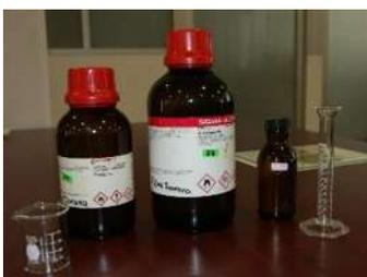
**Preparación de la solución para el spray pirólisis.** Se preparó la solución formadora de la primera capa de titania con tres diferentes reactivos, primero se vertieron 5 mL de etanol absoluto, enseguida se agregaron 3 mL de acetil-acetona y por último 3 mL de isopropóxido de titanio. Se colocó la solución en el recipiente de la pistola conectada con el nitrógeno para comenzar con el spray pirólisis.
