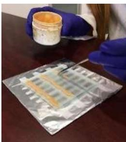
**Técnica de doctor Blade.** Se hicieron los moldes en el vidrio con cinta adhesiva transparente cristalina dejando espacios de aproximadamente un centímetro. Los electrodos de  $\text{TiO}_2$  fueron depositados sobre el vidrio utilizando la técnica Doctor Blade.
