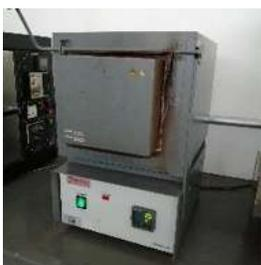
Se retiraron las cintas y después se metió a la mufla con una programación de 0 a 300 °C en una hora, manteniéndose así por 15 min. Después incrementa de 300 a 450 °C en una hora y finalmente se mantiene a esa temperatura por una hora.
