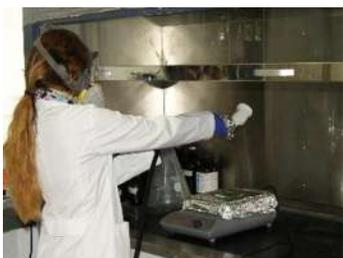
Ya colocado el vidrio FTO en la plancha de calentamiento a una temperatura de 450 °C la cual se dejó durante 10 min, se hizo la primera deposición a una altura de 20 cm. Se apagó la plancha y el vidrio se retiró cuando bajó la temperatura por completo a temperatura ambiente.
