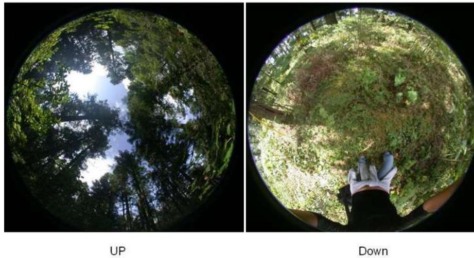
**Figura 1-4. Ejemplo de fotografías hemisféricas tomadas hacia arriba (up) y abajo (down).**
