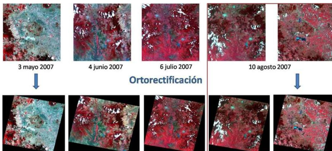
**Figura 2-2. Imágenes SPOT antes (arriba) y después (abajo) de la ortorectificación.**
