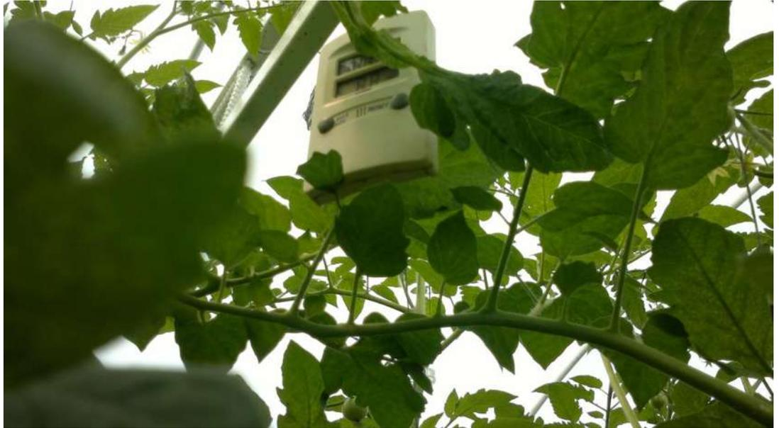
*Figura 40, medidor de temperatura y humedad relativa. fotos: Dinorah Quesada, 2013.*
