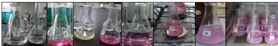
50 ml sol. madre Indicador rojo de metilo, \text{NH}_4\text{OH} 1:1 (color amarillo), HCl 1:3 (color rosa) Agregar agua destilada Calentar y agregar oxalato de amonio 4.2% Calentar en estufa 100^\circ\text{C} / 1:30 hr.
