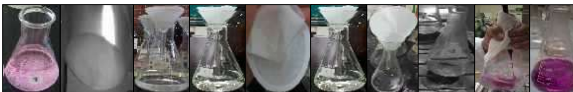
Filtrar y agregar \text{NH}_4\text{OH} 1:50 (color amarillo). Filtrar hasta que la sol. ya no esté turbia. Lavar con agua destilada el papel filtro. Tirar el sobrenadante y agregar 100 ml de \text{H}_2\text{SO}_4 5:60. Calentar Titular con \text{KMnO}_4
