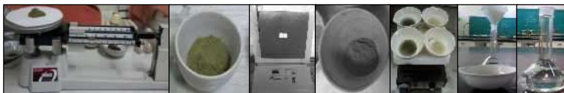
Pesar 2 gr de muestra e incinerar en una mufla a 550^\circ\text{C} / 2 hrs Digestión HCl conc. Filtrar
