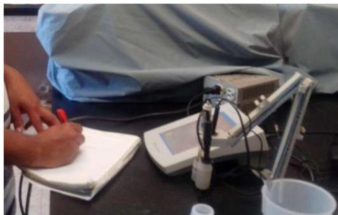
**Figura 12** Medición del pH y C.E. de la solución de riego en arándano 'Biloxi'
