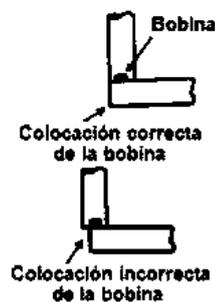
**Figura 2.22** Colocación de bobina para evitar efecto de borde, muestra la colocación correcta en la bobina y la incorrecta en el borde [12].
