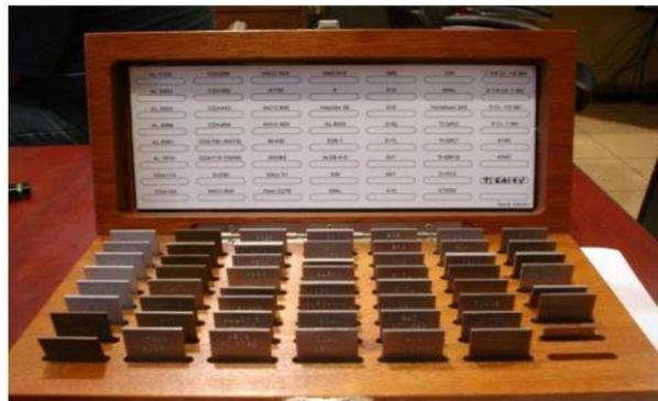
**Figura 3.13** Materiales usados para la calibración de la conductividad eléctrica del equipo de corrientes de Foucault.
