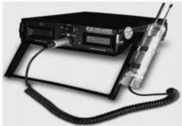
**Figura 3.7** Equipo para medición de potencial termoelectrico.
