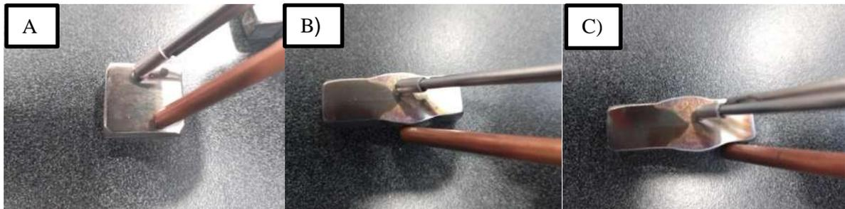
**Figura 3.8** Posiciones de la medición de potencial termoeléctrico A) posición de punta en metal base, B) posición de punta en cordón de soldadura, C) posición de punta en zona afectada térmicamente.
