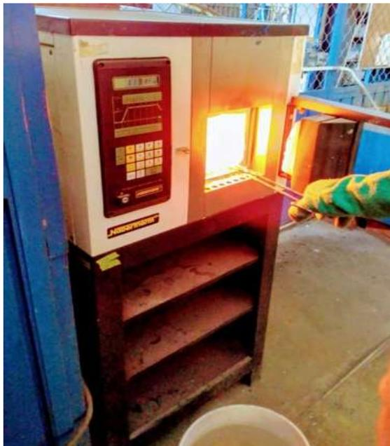
**Figura 3.3** Mufla utilizada para llevar acabo los tratamientos térmicos de solubilizado.
