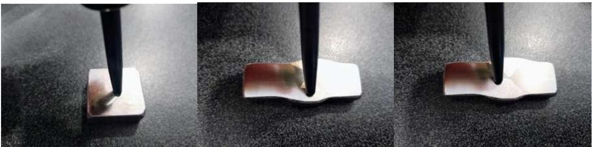
**Figura 3.16** Posiciones de la medición de corrientes inducidas con la sonda tipo lápiz.
