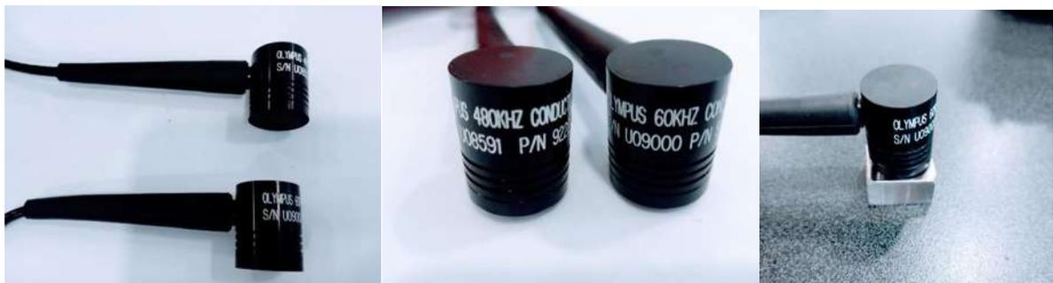
**Figura 3.14** Sondas tipo Pancake de 60 KHz y 480 KHz
