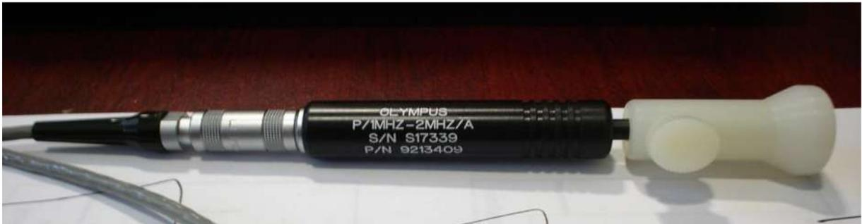
**Figura 3.15** Sonda tipo lápiz con frecuencias de 4-6 MHz.
