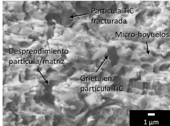
**Figura 4.26** Detalle del área expuesta de fractura del compuesto TiC/Cu-20Ni ensayado al corte por ensayo SPT.
