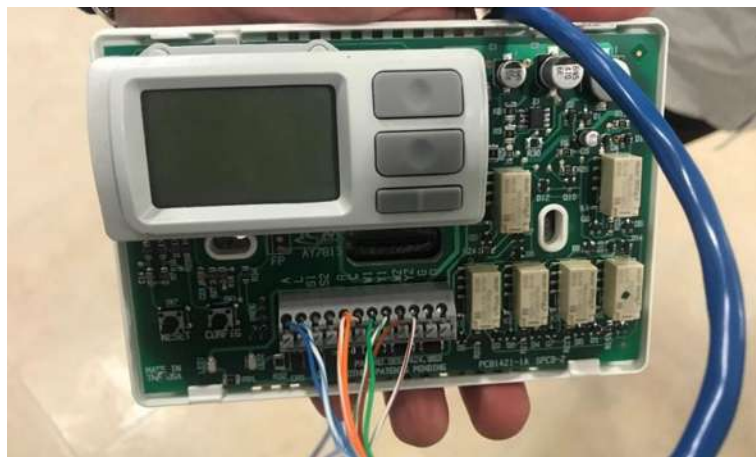
Figura 7. Termostato conectado a la bomba de calor.
