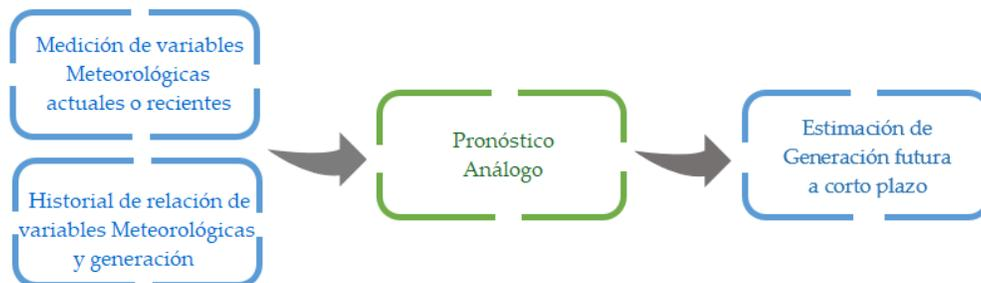
**Figura 3.2** Diagrama de Bloques del Proceso del Pronóstico de Análogo.
