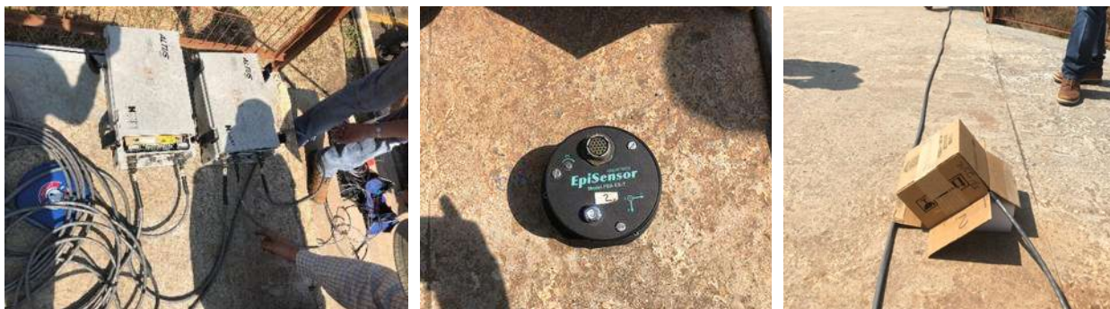
Figura 6.9 Equipo utilizado durante las pruebas de vibración ambiental
