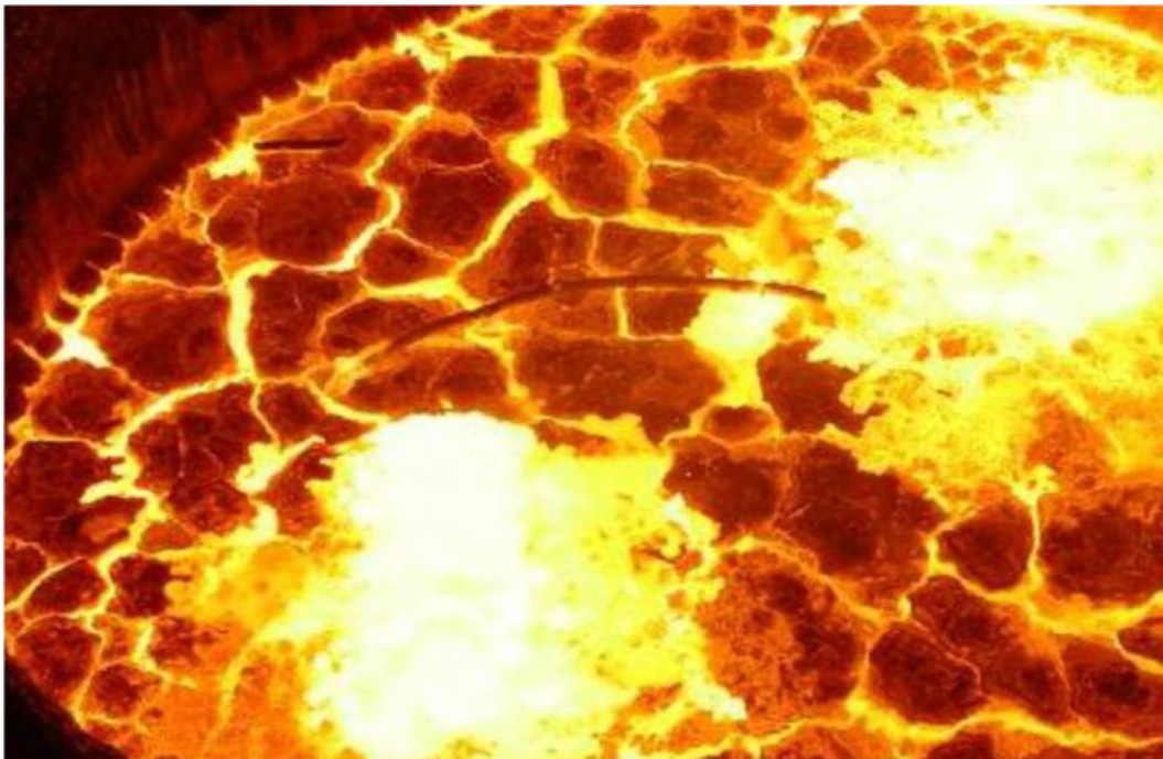
Figura 8. Apertura de la capa de escoria debido a la inyección de gas de dos medios porosos en el proceso real.
