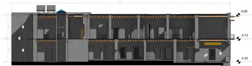
FIGURA. 95. Corte esquemático de la CAMEM con ubicación de lámpara de iluminación artificial en la biblioteca Elaboró: METR
