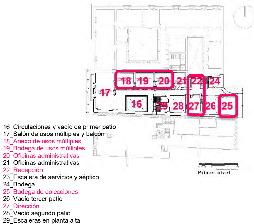
Fig. 129 Distribución arquitectónica numerada de la planta alta de la CAMEM en donde se destacan los espacios con alteraciones estructurales visibles. Elaboró: METR
