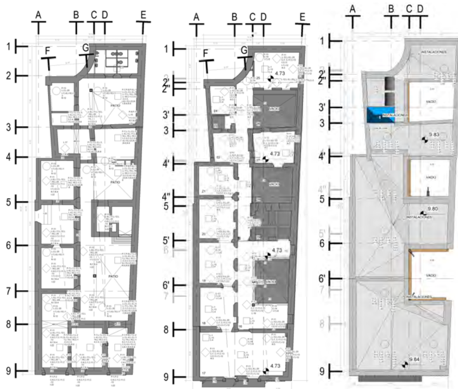
Fig. 163 Planta baja, alta y azotea de la CAMEM con las actividades de restauración. Elaboró: METR
