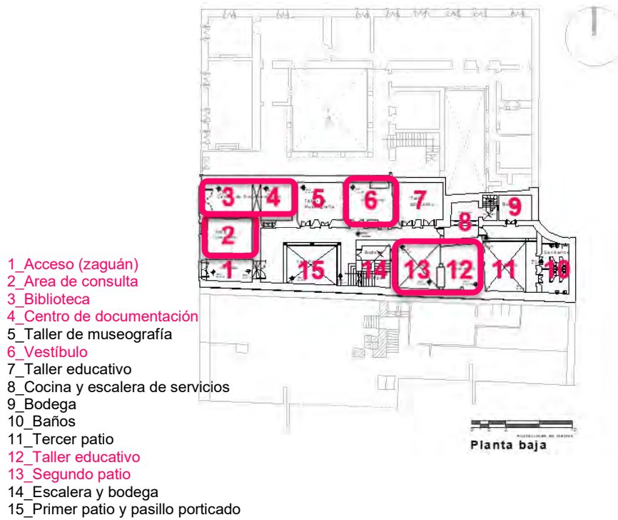
Fig. 128 Distribución arquitectónica numerada de la planta baja de la CAMEM en donde se destacan los espacios con alteraciones estructurales visibles. Elaboró: METR
