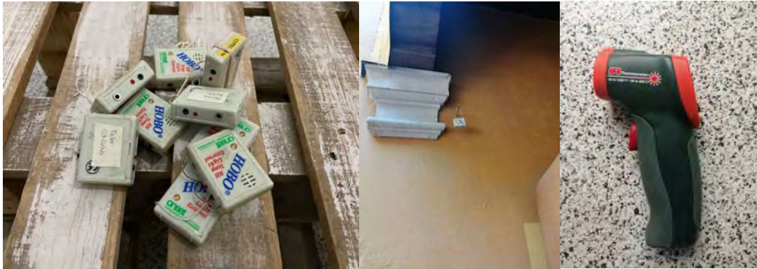
FIGURA. 71 Aparatos de monitoreo Hobo Ware by Onset, colocación de los mismos en los espacios y thermometer laser para temperatura superficial. Elaboró: Equipo de monitoreo proporcionado por el departamento de investigación bioclimática de posgrado FAUM, UMSNH, supervisión Dra. Katia Simancas Jovane y Dr. Habid Becerra Santacruz
