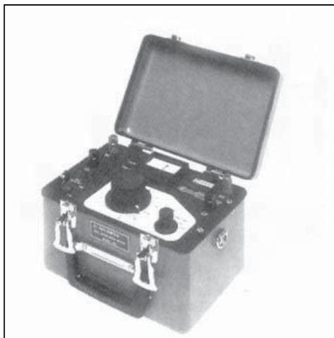
**Fotografía 9. El medidor digital de la resistencia del suelo de cuatro clavijas.**
