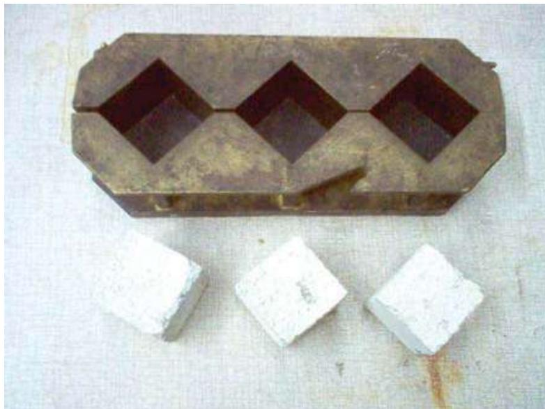
Fotografía 2. Molde para cubos de prueba.
