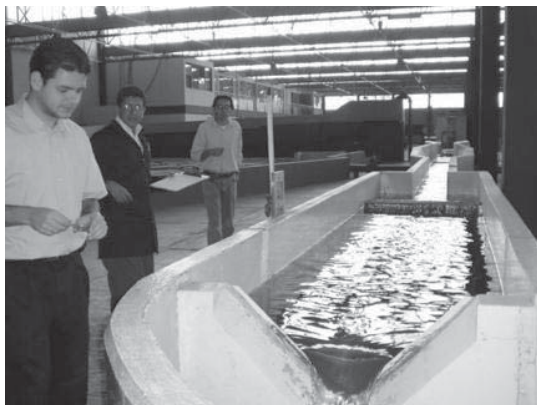
Medición del Gasto que pasa por la Compuerta por medio de un vertedor de Pared Delgada.
