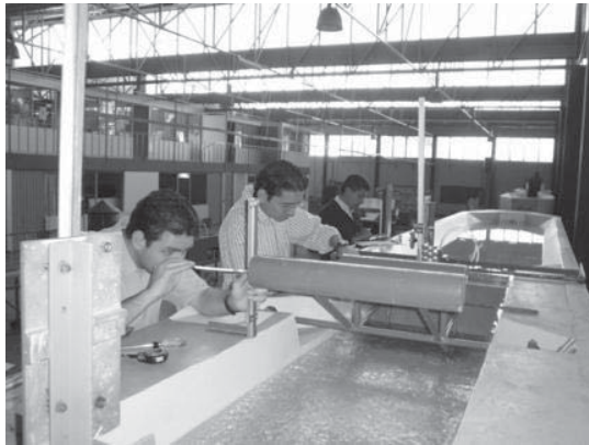
Medición de la abertura de la Compuerta Amil.
