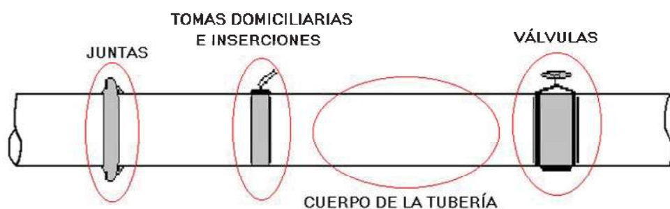
Tipos de fuga en la infraestructura de distribución de agua potable
