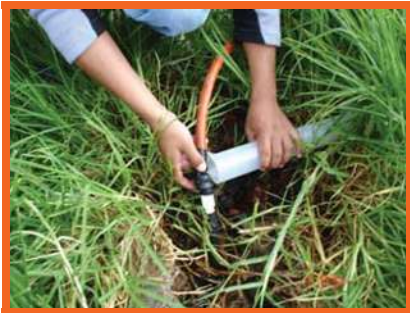
Aforo de una fuga visible empleando una probeta graduada y un cronometro
