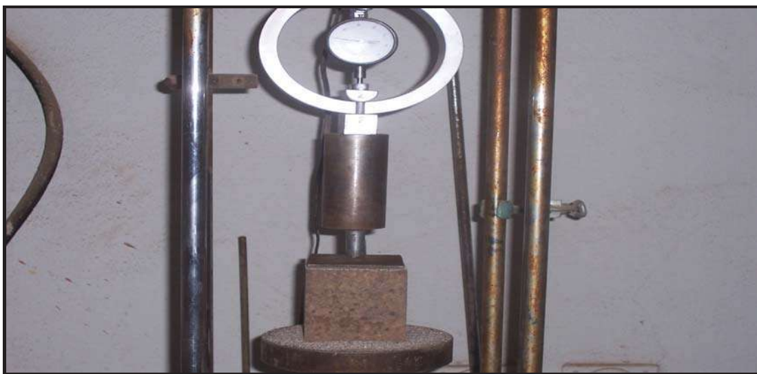
Foto 7.- Especimen sometido a carga de ruptura.
