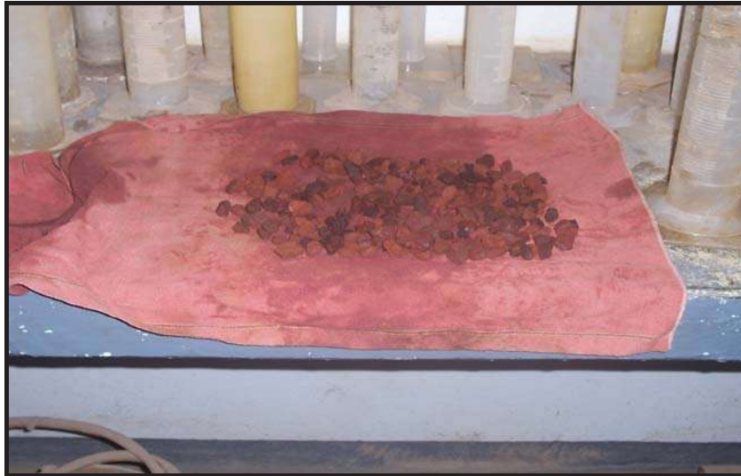
Foto 6.- Secado superficial del espécimen.
