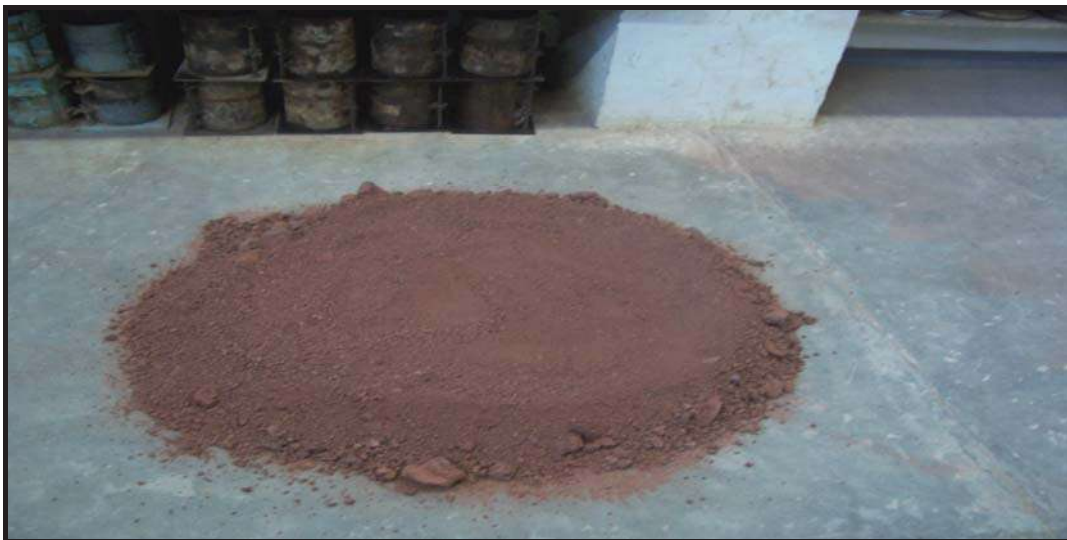
Foto 2.- Cono truncado para posteriormente separarlo en cuadrantes.
