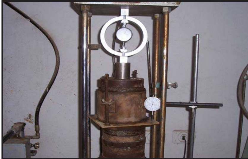
Foto 13 .- Espécimen cargado para conocer su penetración.
