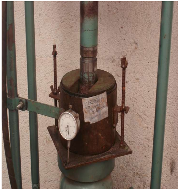
Figura no. 17 penetraciones del material de base
