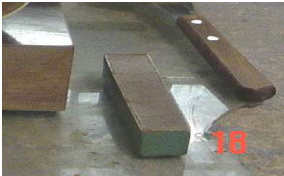
Figura no. 9 molde con la muestra para determinar la contracción lineal
