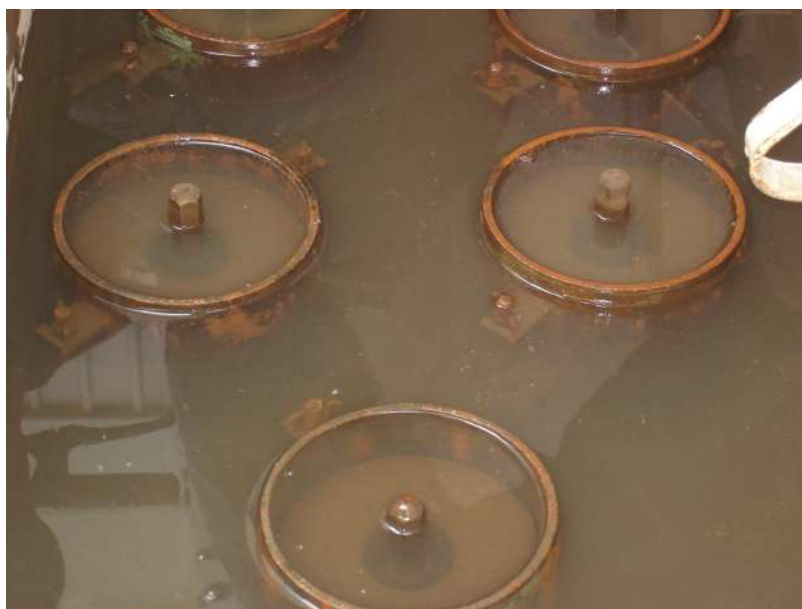
Figura no. 15 moldes en agua para determinar la expansión del material
