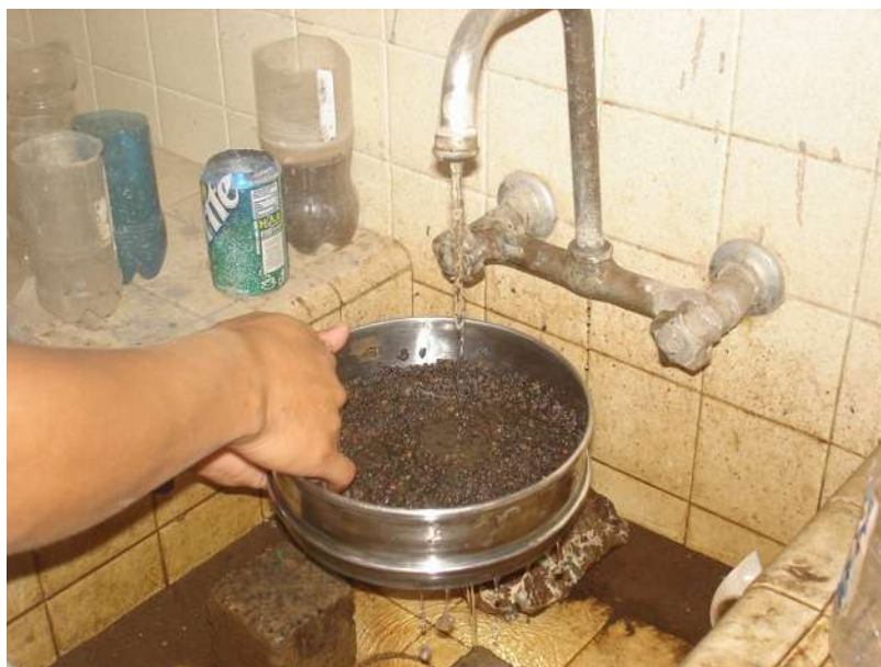
Figura no. 13 granulometría por lavado con agua a baja presión
