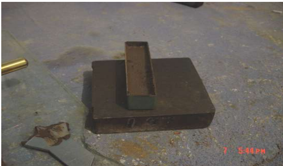
Figura no. 8 molde para determinar la contracción lineal
