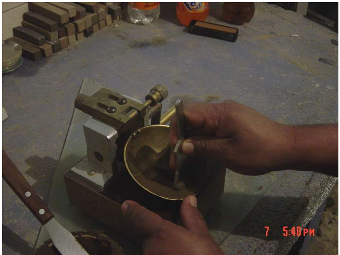
Figura no. 4 ranurador perpendicular a la superficie de la copa.
