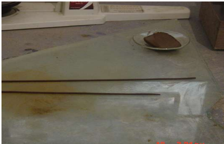
Figura no. 7 cilindros de 3 mm de espesor al momento de agrietarse
