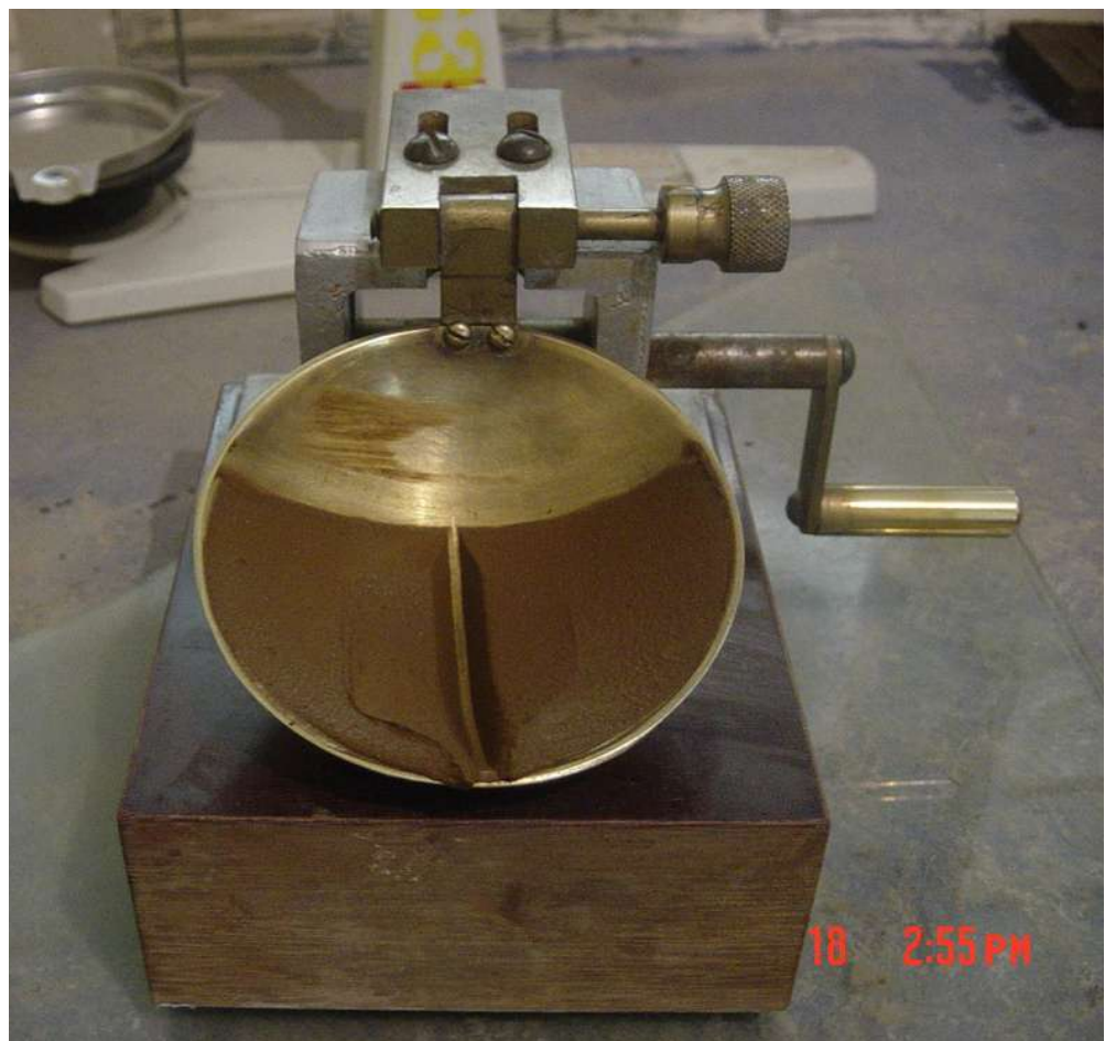
Figura no 5 material ranurado en la copa de casagrande
