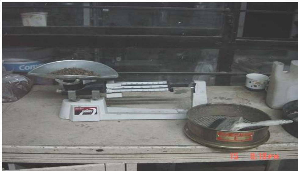
Figura no. 12 pesado de material en una balanza con aproximación a 0.1 de gramo
