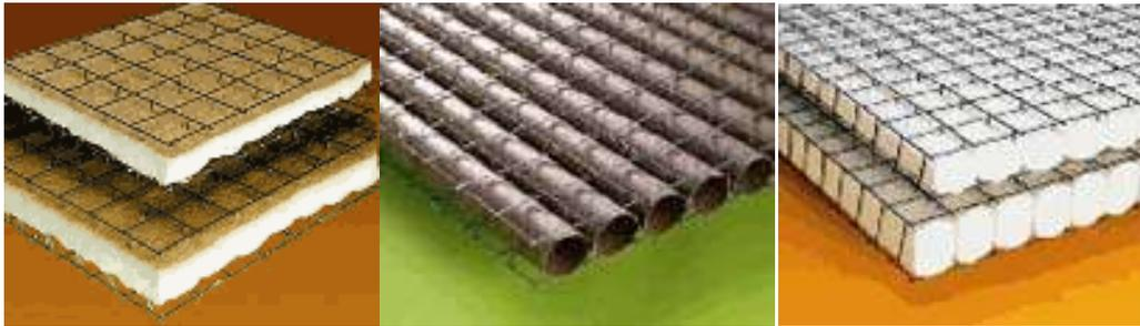
Entre otras cosas el panel divisorio, nos sirve para construir muros tapón y detalles arquitectónicos en interiores, a diferencia de los estructurales estos no tienen capacidad para soportar ningún tipo de carga. Es una estructura tridimensional de alambre de acero pulido de alta resistencia, que lleva al centro un alma de poliestireno expandido.
