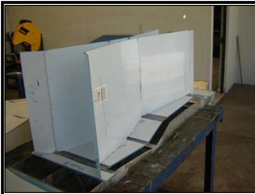
Figura 11. Las paredes del aforador se cortaron en una sola pieza, la cual fue sometida a un proceso termo-eléctrico para doblarla y así obtener la forma del diseño.
