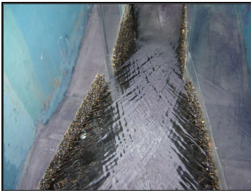
Figura 40. Rugosidad dentro del dispositivo aforador
