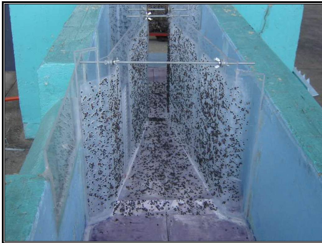
Figura 38. Aforador forrado simulando el cambio en la rugosidad
