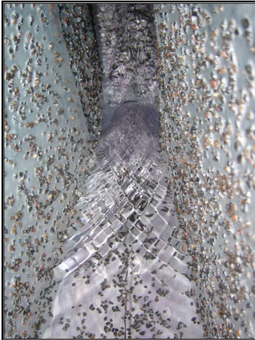
Figura 39. Flujo circulando a través del aforador
