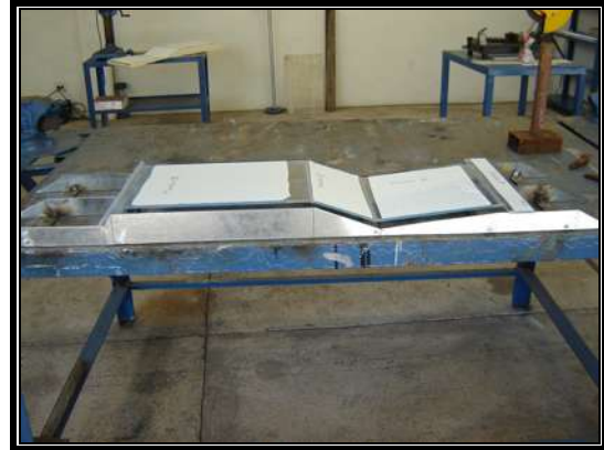
Figura 10. Se fabricó una estructura de soporte para darle mayor estabilidad a la plantilla.
