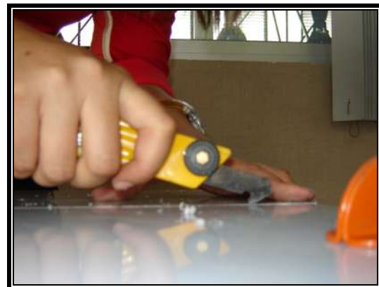
Figura 8. Se cortaron las piezas con mucho cuidado para mantener las medidas lo más exactas posible.
