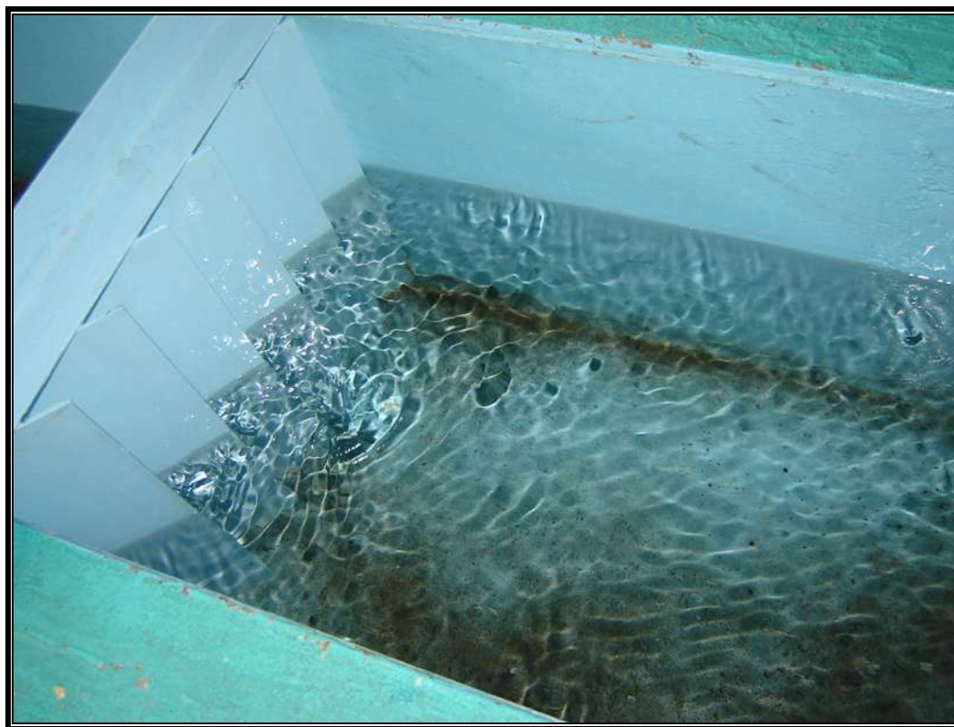
Figura 31. Perturbación causada por la rejilla tipo peine
