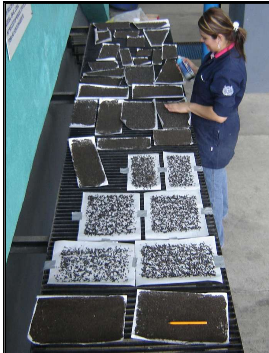
Figura 37. Distintos tamaños de grano para cambiar el coeficiente de rugosidad
