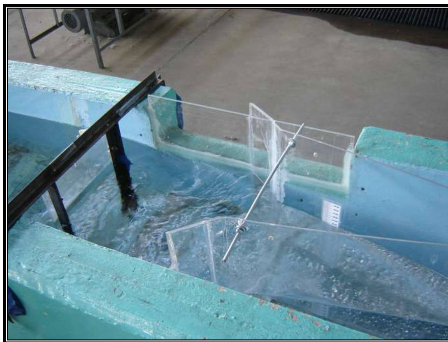
Figura 28. Vórtices formados en el flujo a la entrada del aforador Parshall
