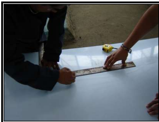
Figura 7. Se marcaron las dimensiones del aforador en el acrílico
