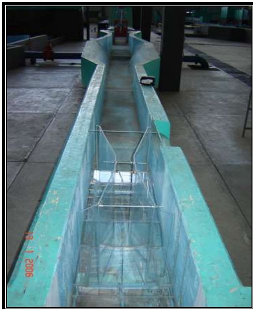
Figura 17. Vista aguas arriba del aforador colocado en el canal.
