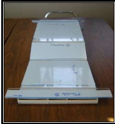
Figura 9. La plantilla del canal se cortó y pegó en secciones.
