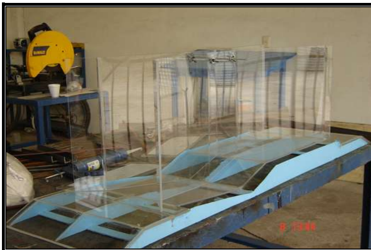
Figura 13. El aforador fue armado y pegado, y está listo para instalarse.
