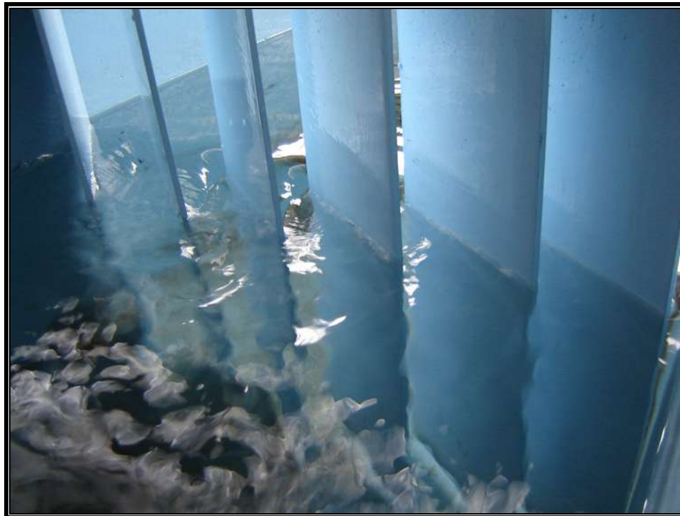
Figura 32. Pequeños vórtices en el flujo aguas arriba del aforador
