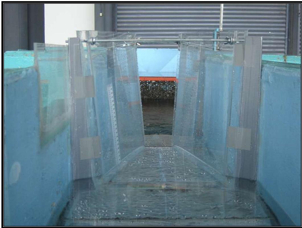
Figura 34. Flujo circulando a través del aforador modificado
