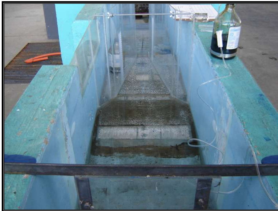
Figura 27. Pantalla perturbadora ubicada aguas arriba del aforador
