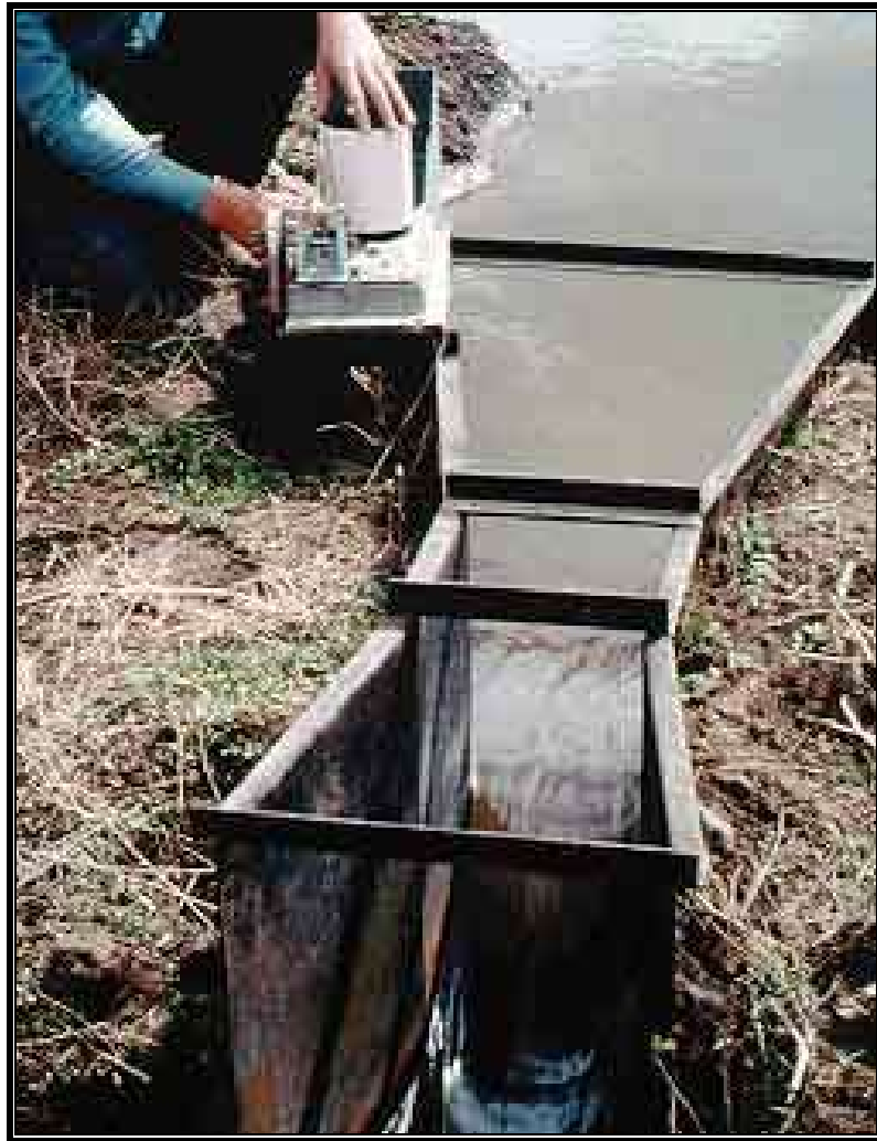
Figura 1. Aforador tipo Parshall trabajando a descarga libre en campo
