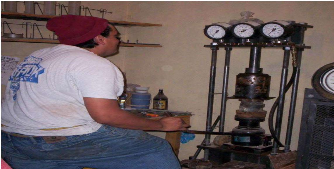
Foto 6.- Espécimen porter sujeto a la penetración del valor relativo de soporte
