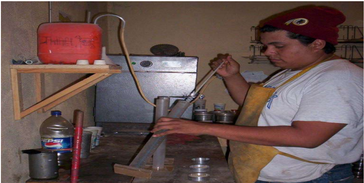
Foto 12.- Determinación del equivalente de arena.
