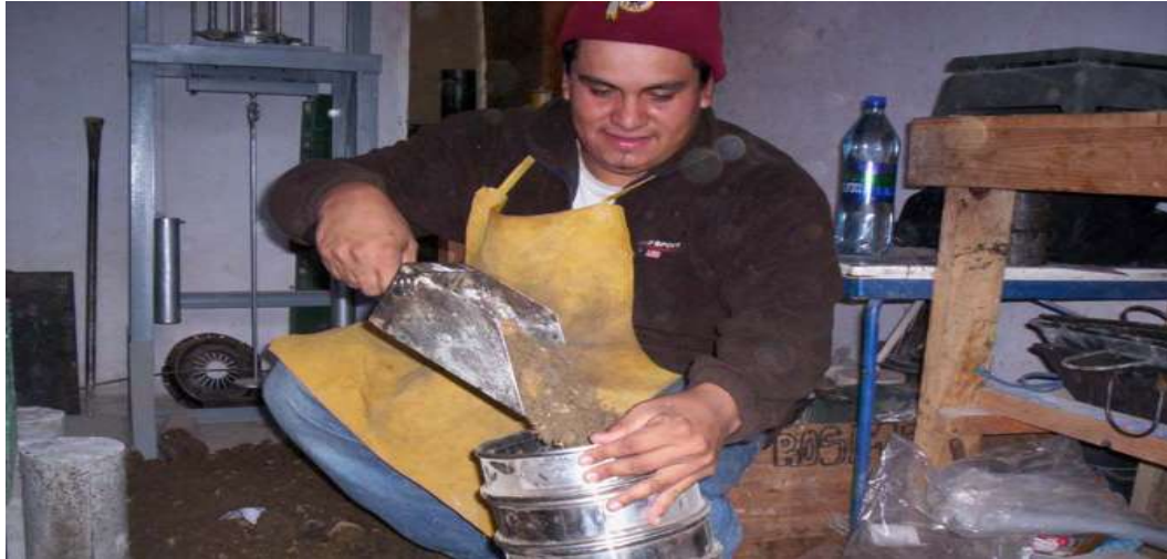
Foto 3.- Juego de tamices empleados en la granulometria.
