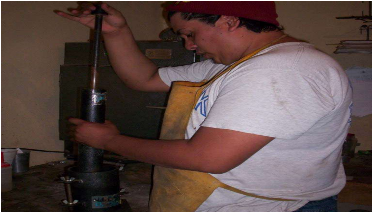
Foto 8.- Realización del ensaye proctor.
