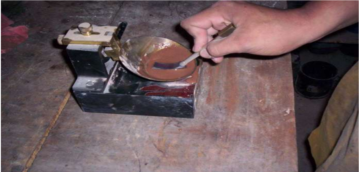
Foto 11.- Determinación del limite liquido.
