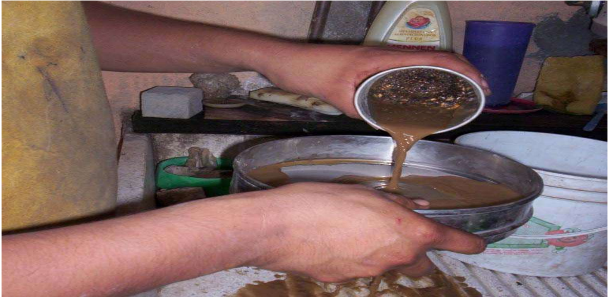
Foto 7.- Análisis granulométrico mediante lavado.
