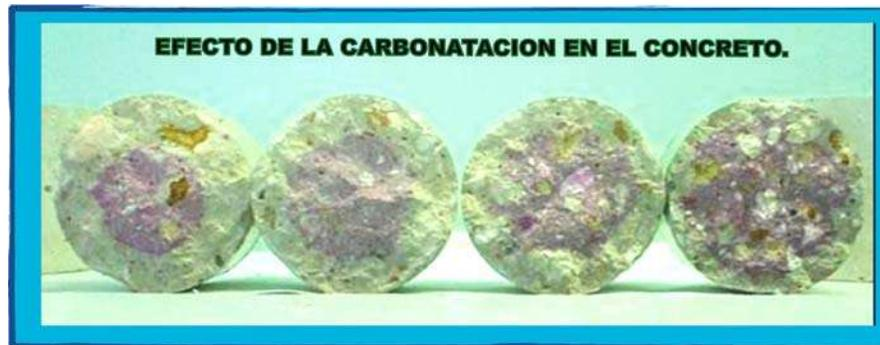
**Fig. 3. Prueba de carbonatación en concreto.**
