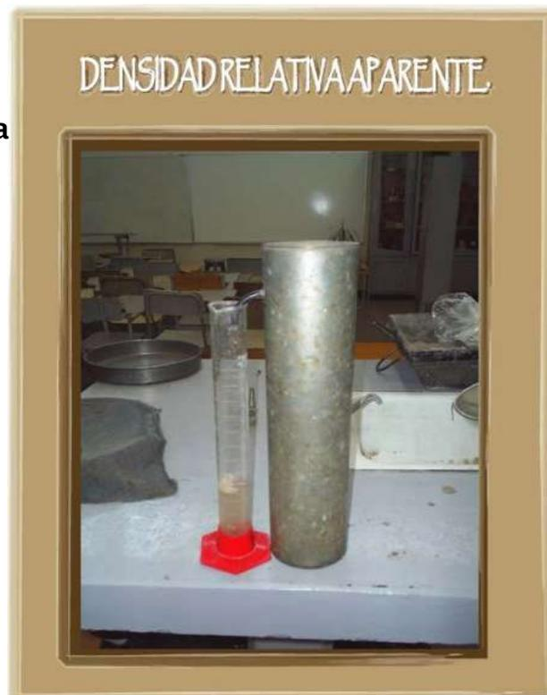
Fig. 7. Prueba de Densidad Relativa Aparente.
