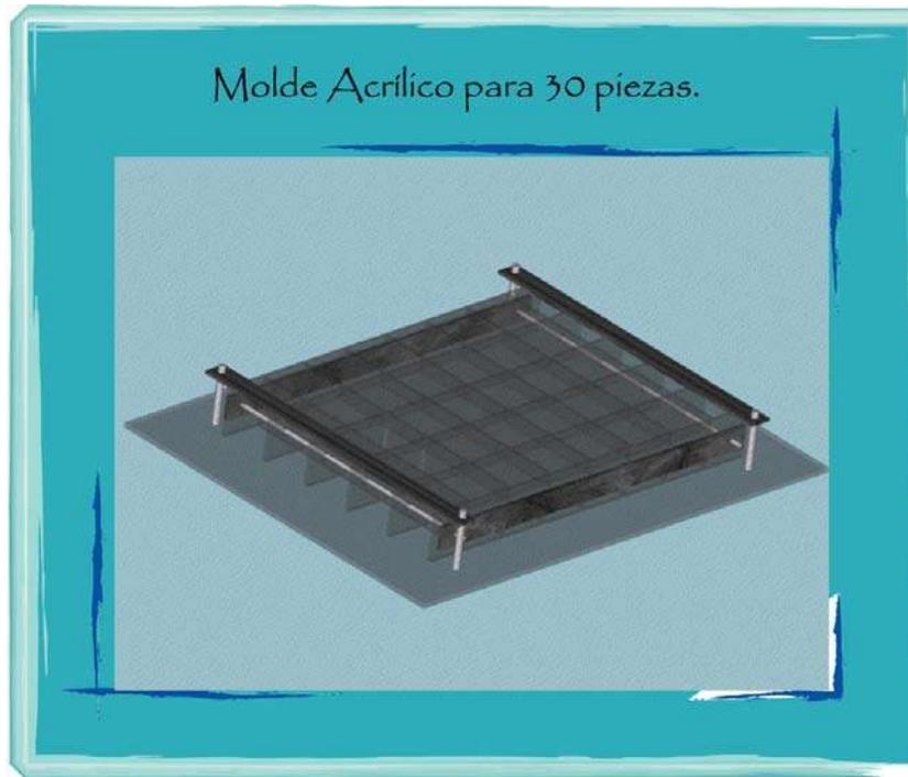
Fig. 11. Diseño del molde para cubos. Diseño M. Quintero Márquez.
