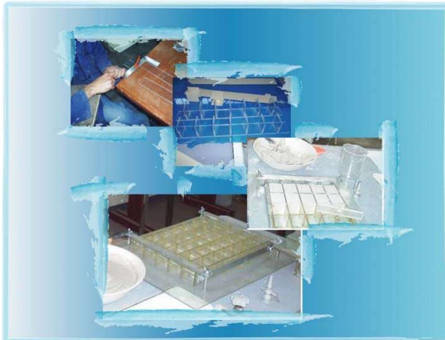
Fig. 12. Proceso de elaboración del molde de Acrílico. Foto M. Quintero Márquez.
