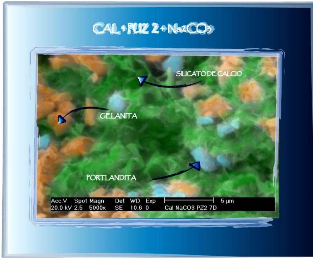
Fig. 23. Fotomicrografía de una cal con puzolana 2 y Na<sub>2</sub>CO<sub>3</sub> a 5000 X.
