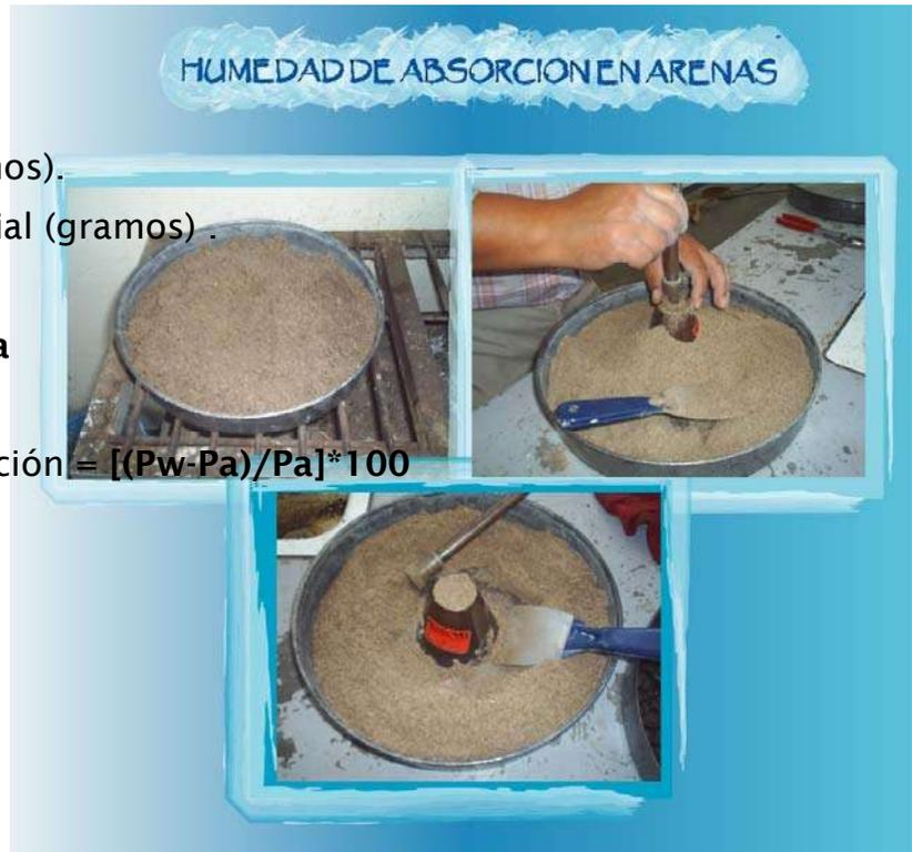
Fig. 6. Procedimiento de la prueba de humedad de absorción en arenas.
