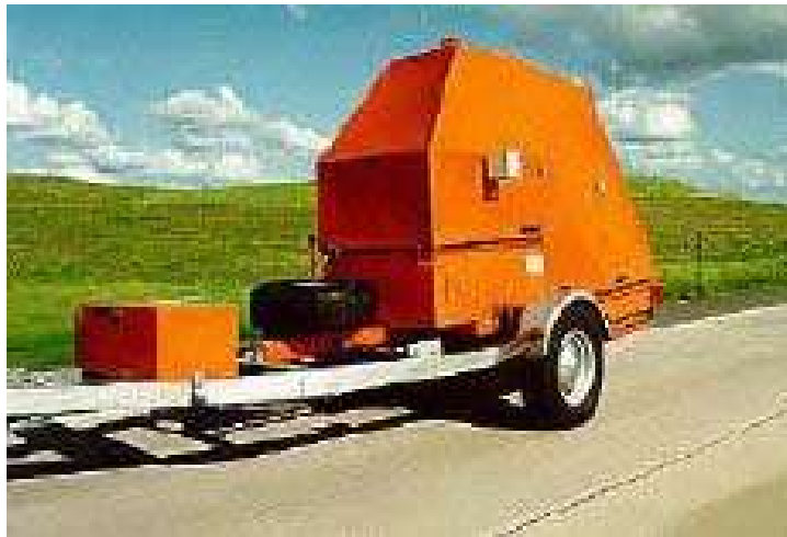
Figura 1.4. Equipo dinámico para la determinación de deflexiones (Dynaflect)
