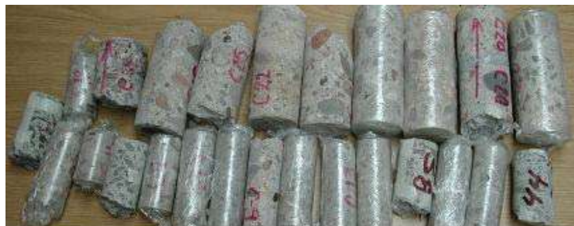
Figura IV.1 Testigos de concreto empleados en la prueba de resistencia a la compresión. [30]
