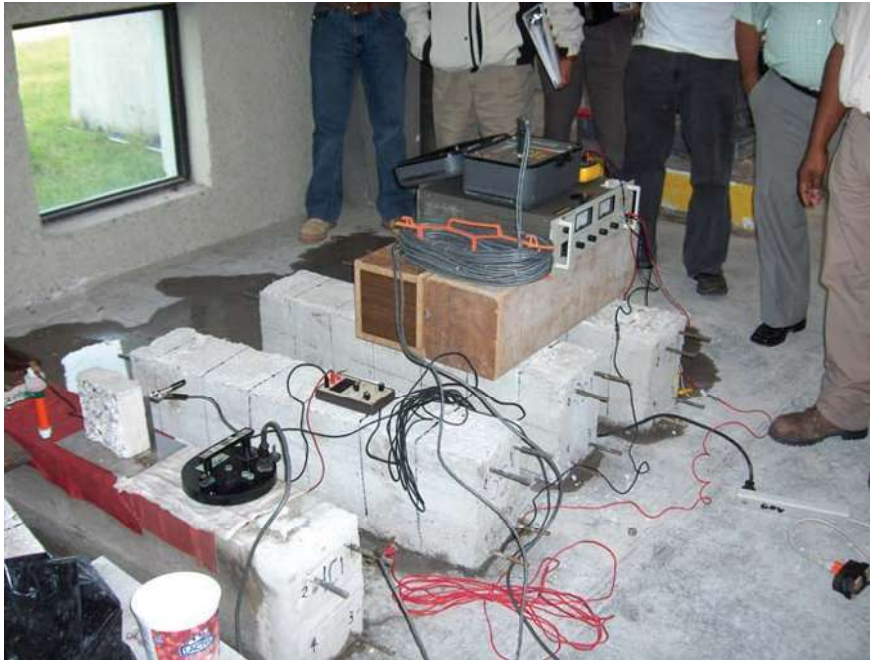
Figura IV.5. Medición de Potenciales de una armadura
