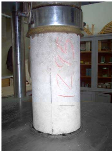
Prueba de compresión en concreto
