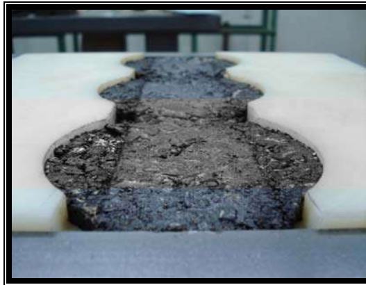
Figura 7.19 Deformación provocada por la rueda.
