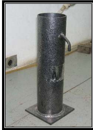
Figura 7.5 Picnómetro para determinación de densidad de gravas
