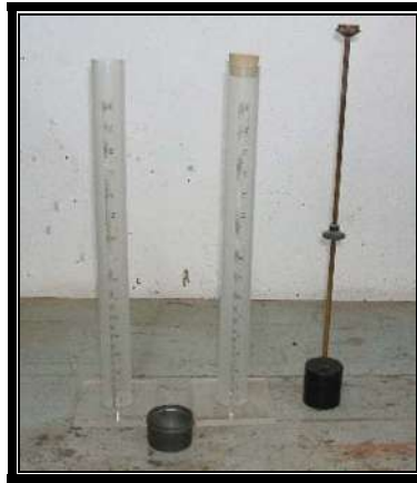
Figura 7.6 Equipo para la obtención del equivalente de arena
