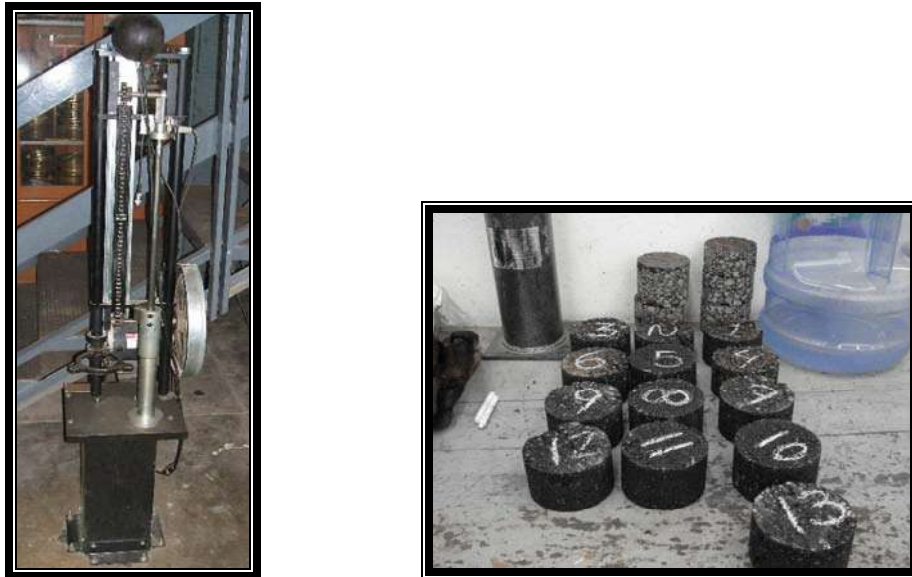
Figura 6.17 Compactador (izq.), Probetas Marshall (der.)
