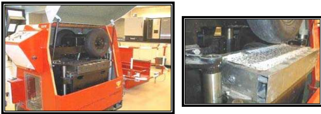
Figura 6.7 Máquina FWT , interior y detalle de la probeta.
