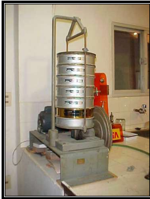
Figura7.3 Mallas y equipo mecánico de cribado
