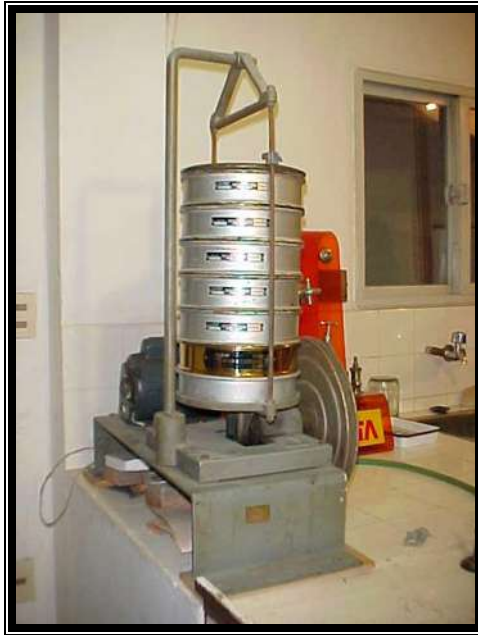
Fig. 4.3 Mallas y equipo mecánico de cribado
