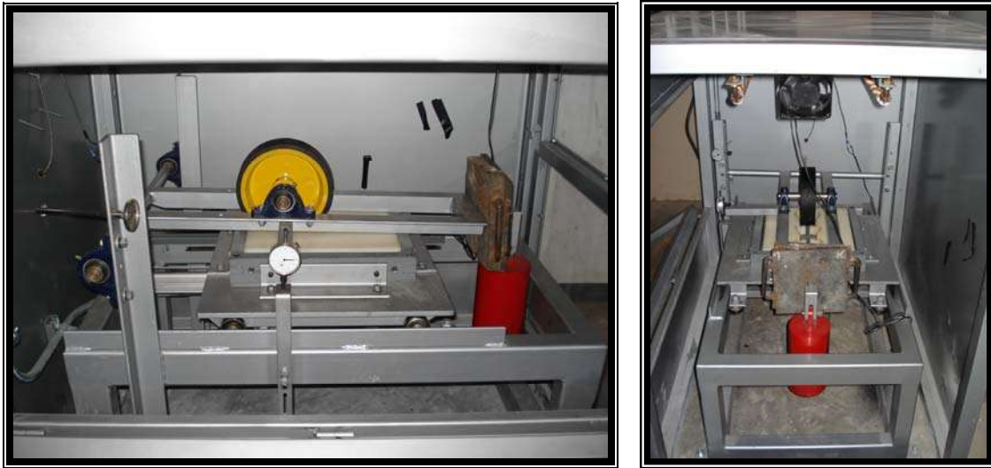
Fig. 3.13 Vista Frontal (izquierda) y lateral (derecha) de la unidad de aplicación de carga
