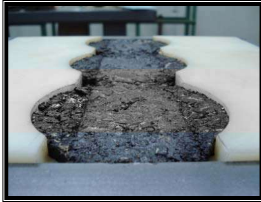
Fig 4.18 Deformación provocada por la rueda
