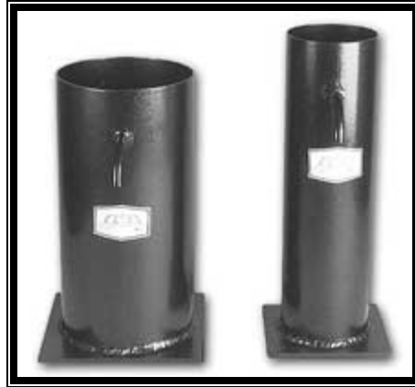
Fig. 4.5 Picnómetro para determinación de densidad de gravas
