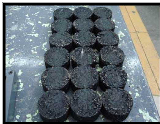
Fig 4.17 Pastillas ensayadas en la pista de ensayo
