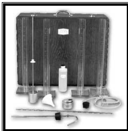
Fig.4.6 Equipo para la obtención del equivalente de arena
