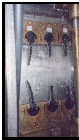
Fig. 1.23 Ensayo de recuperación elástica en ductilometro
