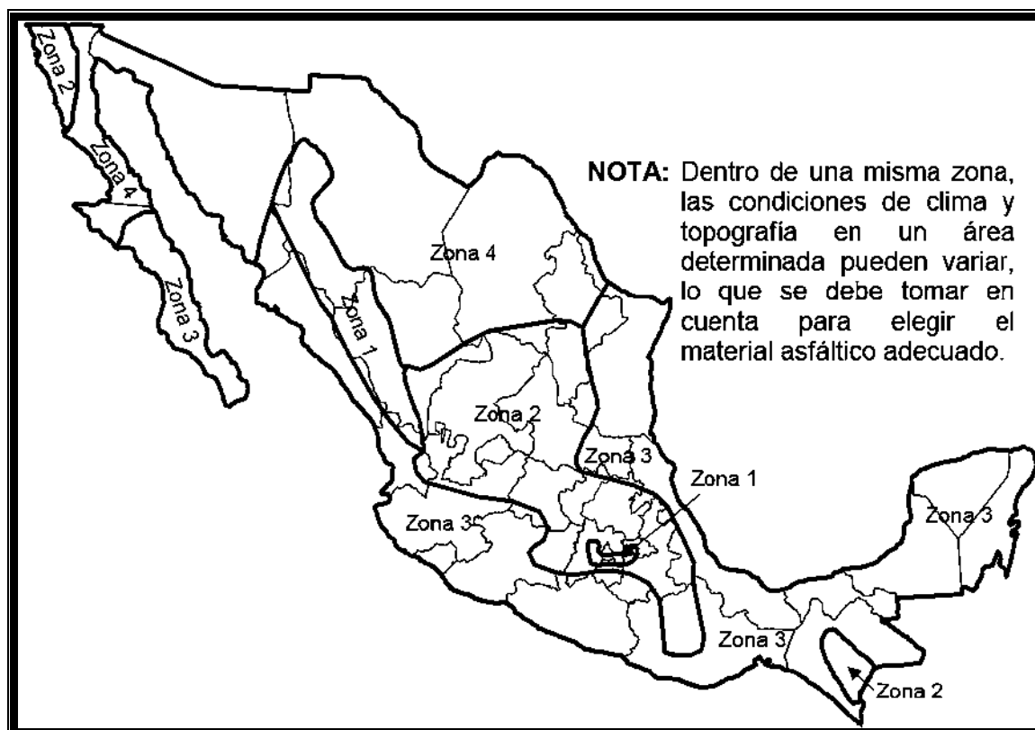
Fig.1.19 Regiones geográficas para la utilización de asfaltos clasificados según su viscosidad dinámica a 60°C.
