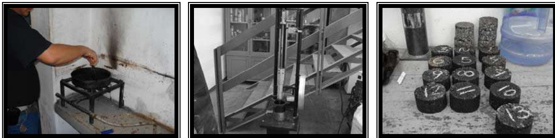
Fig. 3.14 Mezclado (izq.), Compactación (centro) y probetas Marshall (der.)
