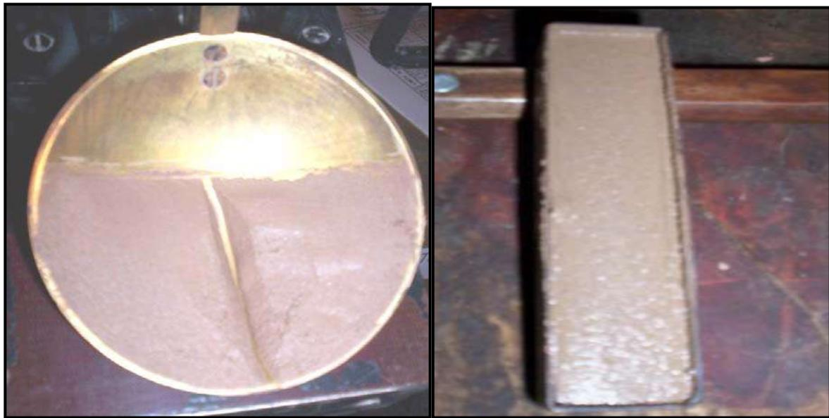
**Fotografías 76 y 77.- RANURA EN LA COPA DE CASAGRANDE Y LLENADO DE LA BARRA, PARA CONTRACCION LINEAL.**
