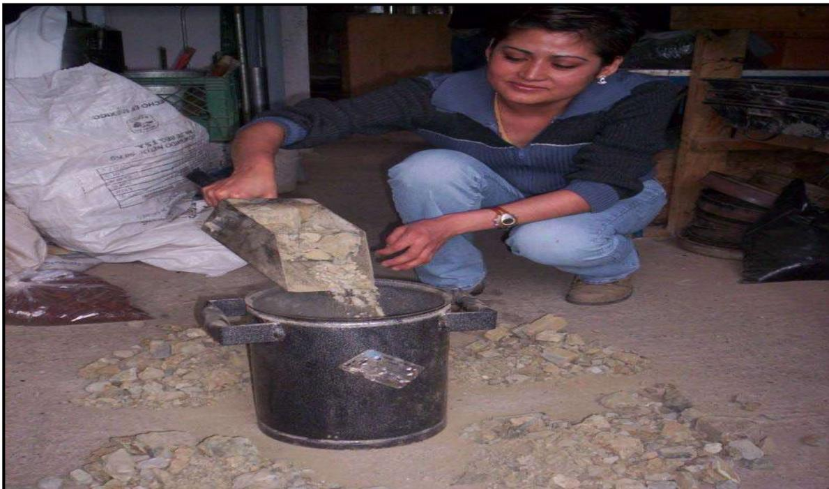
**Fotografía 70.- DETERMINACION DEL P.V.S.S. (PESO VOLUMETRICO SECO SUELTO).**
