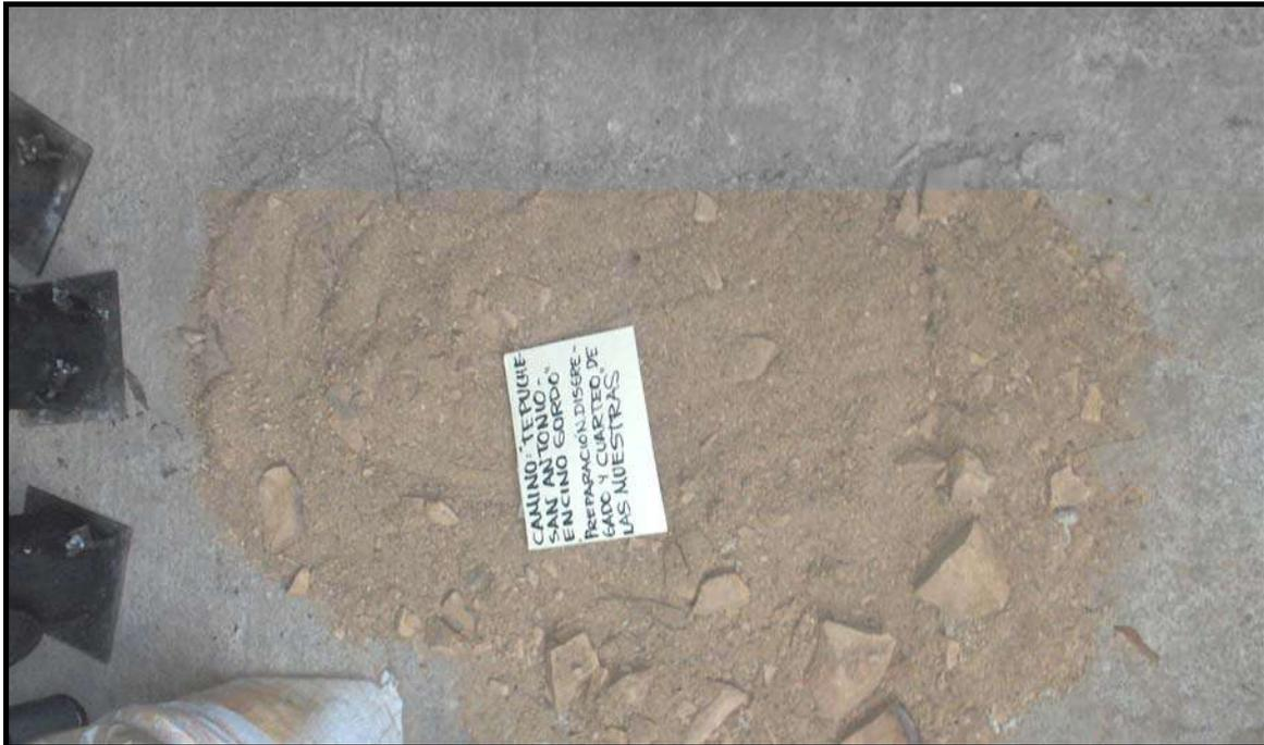
**Fotografía 69.- SECADO Y DISGREGADO DE MUESTRAS.**
