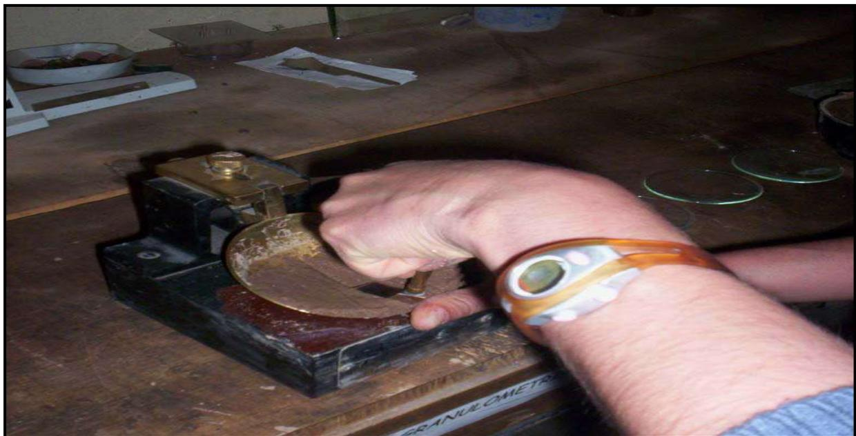
**Fotografía 78.- DETERMINACION DEL LIMITE LIQUIDO, CON LA COPA DE CASAGRANDE.**
