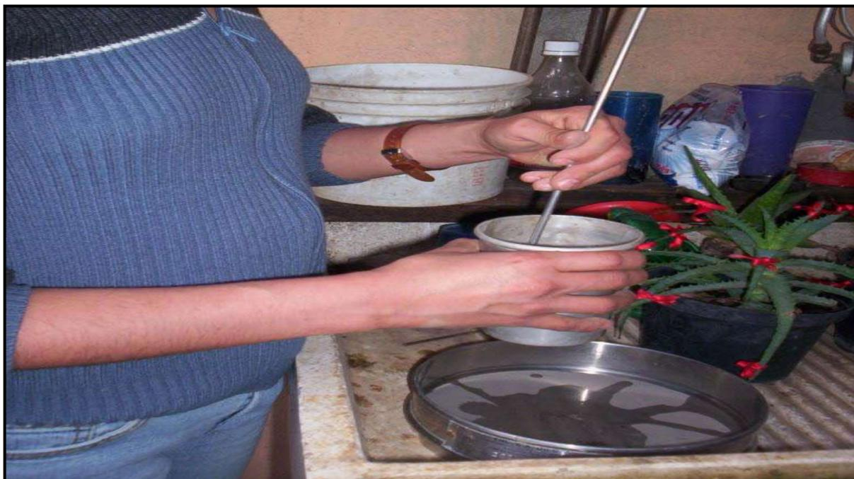
**Fotografía 75.- LAVADO DE LA GRANULOMETRIA CHICA MEDIANTE EL TAMIZ 200.**
