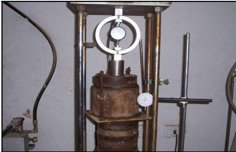
*Foto 13 .- Espécimen cargado para conocer su penetración.*
