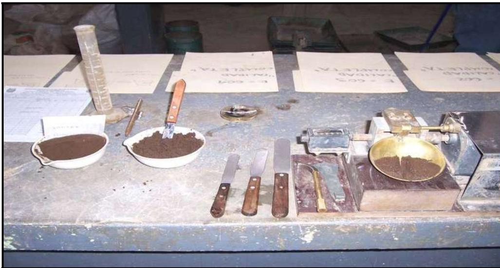
*Foto 9.- Equipo para la determinación del limite liquido.*
