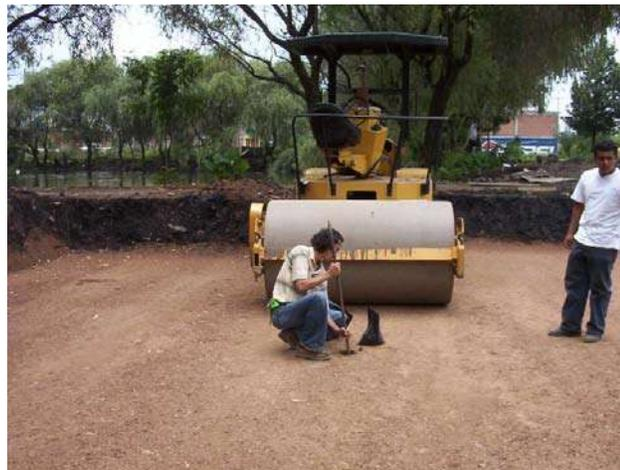
**Ilustración 3.- TOMA DE MUESTRAS PARA LAS PRUEBAS DE COMPACTACIÓN**
