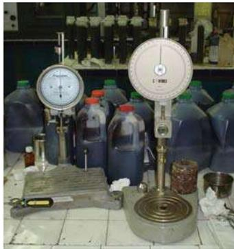
Figura 6.7 Equipo para realizar la prueba de penetración en el asfalto.
