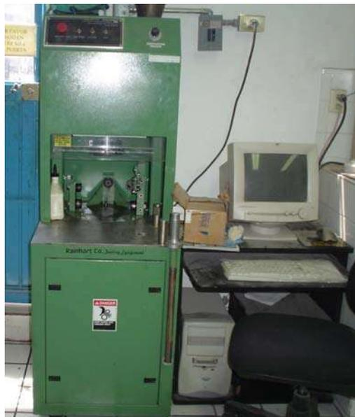
Figura 6.14 Compactador giratorio SHRP.
