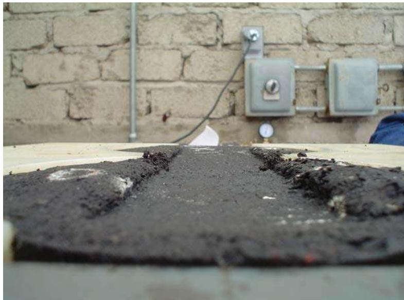
Figura 6.19 Probeta ensayada a una temperatura de grado PG (76° C).
