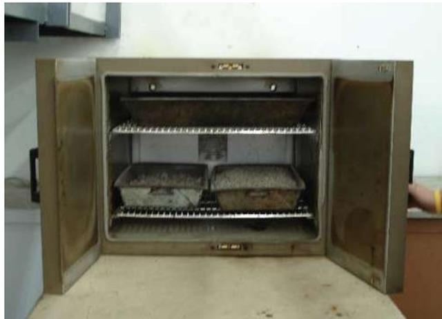
Figura 6.11 Horno para calentar el agregado y el asfalto.
