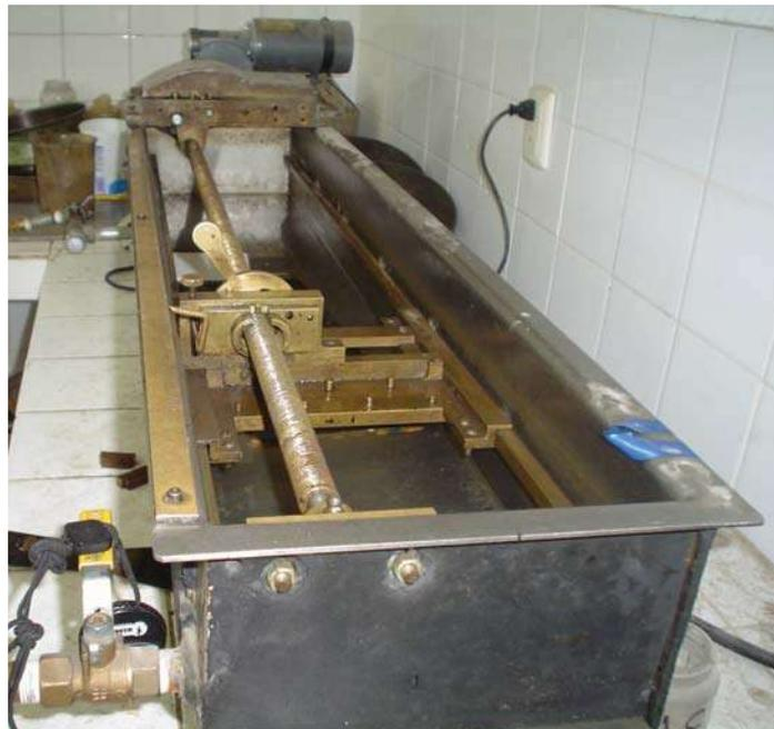
Figura 6.10 Equipo para realizar la prueba de ductilidad.
