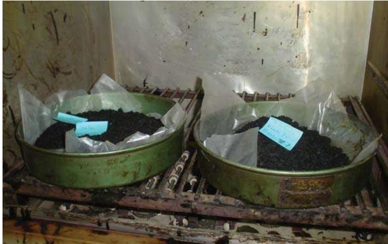
Figura 6.13 Calentamiento del agregado antes de la compactación.
