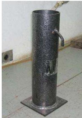
Figura 6.3 Picnómetro para determinación de densidad de gravas.
