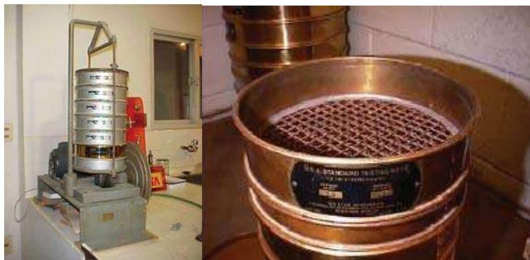
Figura 6.2 Equipos empleados para obtener la granulometría del material.
