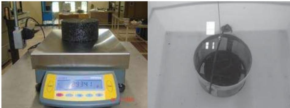
Figura 6.15 Determinación de la gravedad específica total.
