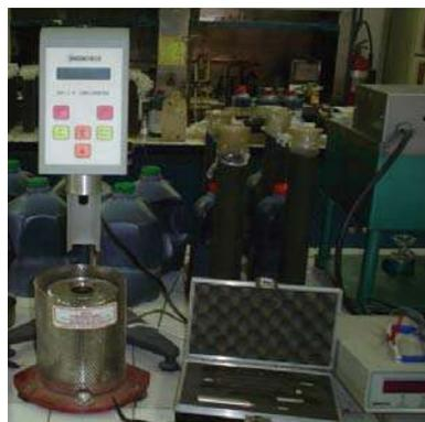
Figura 4.5 Viscosímetro rotacional.
