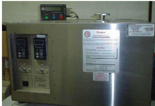
Figura 4.7 Cámara de Envejecimiento a Presión.
