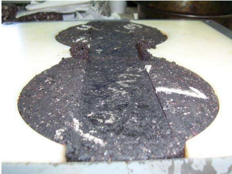
Figura 6.18 Probeta ensayada a una temperatura de 60° C.
