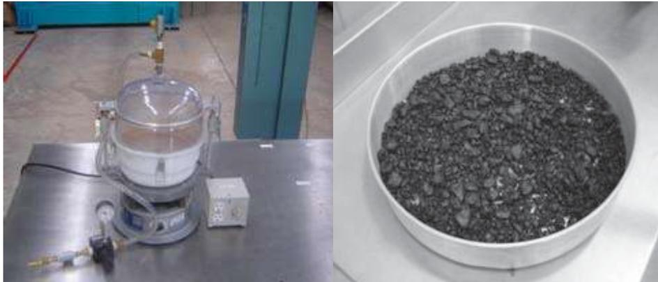
Figura 6.16 Determinación de la gravedad específica teórica máxima.
