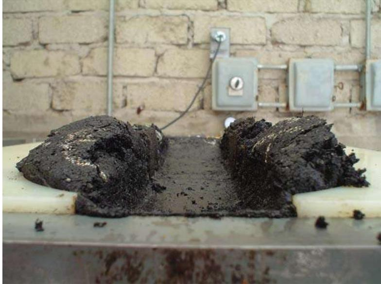
Figura 6.20 Probeta ensayada a una temperatura de falla + 3°C (82° C).
