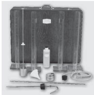
Figura 6.4 Equipo para la obtención del equivalente de arena.
