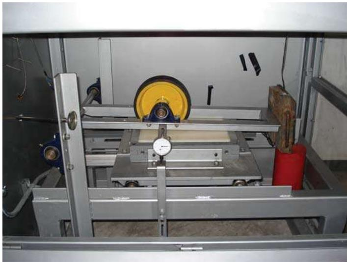
Figura 5.11 Unidad de aplicación de carga.
