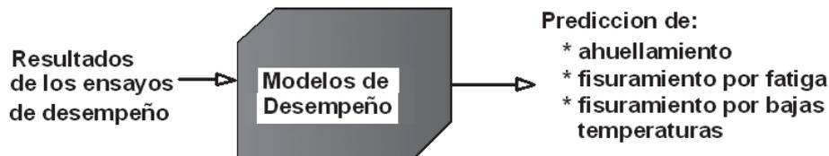
Figura 2.6 Predicción de la performance del pavimento de SUPERPAVE (fuente: Asphalt Institute, 1998).
