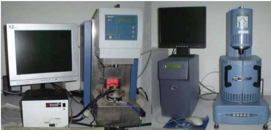
Figura. 4.1. Diferentes modelos de Reómetro de Corte Dinámico.
