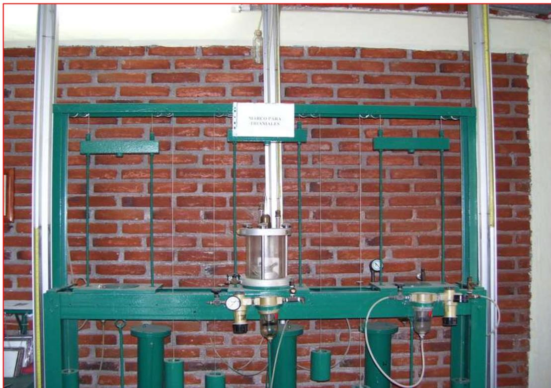
**Figura III.5.-** Equipo de laboratorio para pruebas triaxiales.
