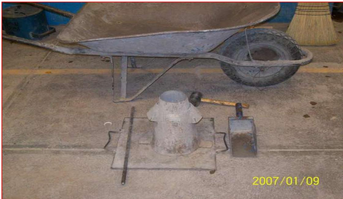
**Figura V.2.-** Equipo para prueba de revenimiento.
