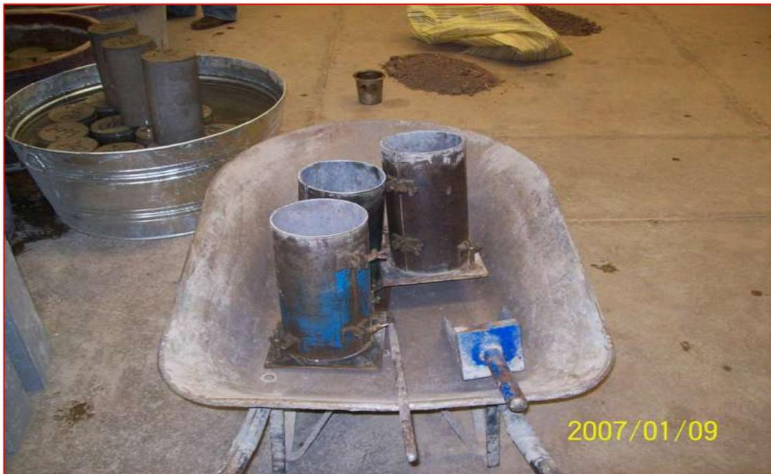
**Figura V.3.-** Equipo de fabricación de cilindros para prueba.
