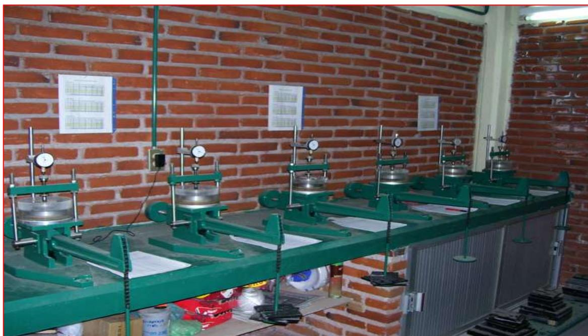
**Figura III.6.-** Equipo para pruebas de consolidación.
