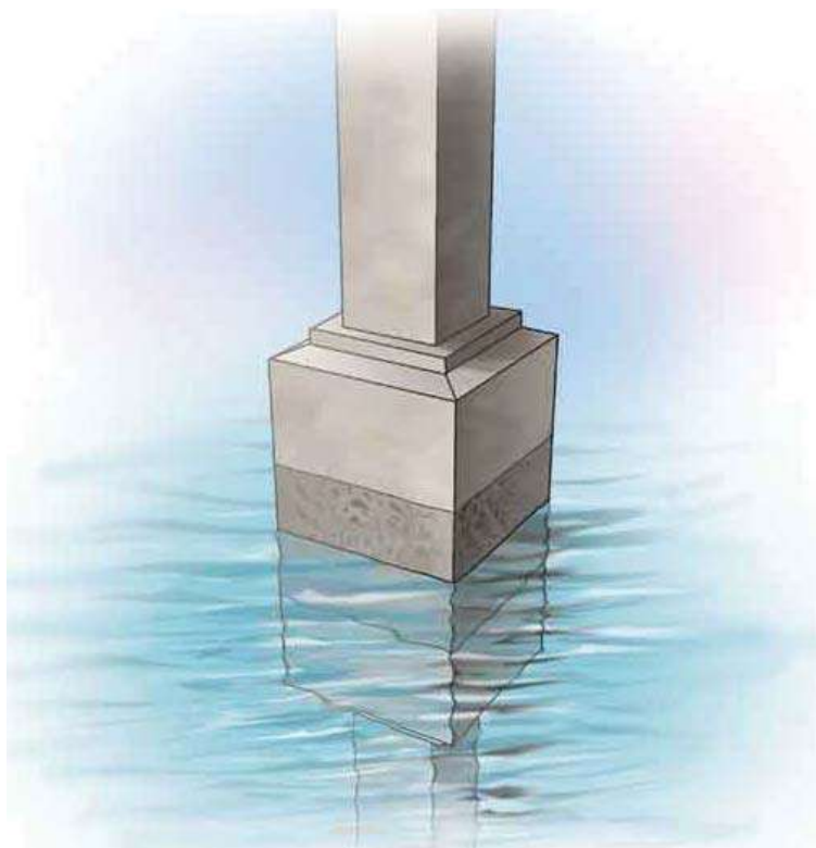
Fig. 21. Ataque de cloruros y sulfatos contra el concreto. 3
