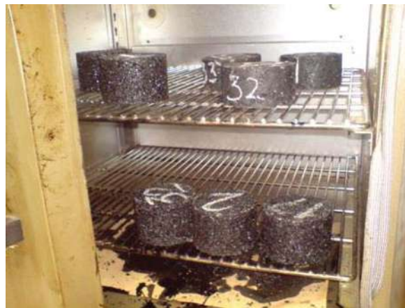
Figura 5. 15.- Probetas en el horno eléctrico calibrado a la temperatura para ser probadas
