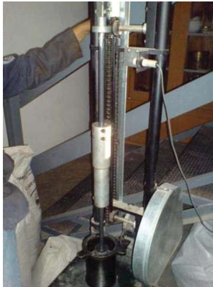
Figura 5. 6.-Máquina compactadora Marshall
