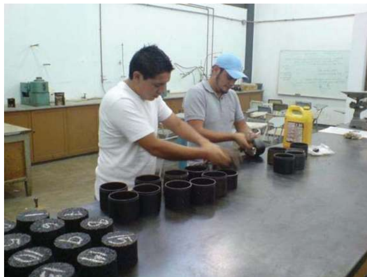
Figura 5. 8.- Limpieza de los moldes después de la fabricación.
