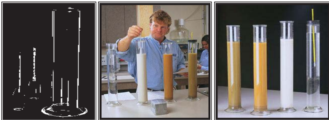
Figura 5.12). _Análisis del suelo fino utilizando el hidrómetro.
