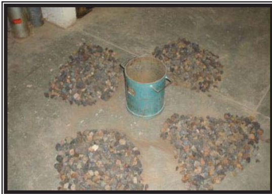
Figura 5.10)._Equipo necesario para determinar la distribución granulométrica en suelos gruesos.
