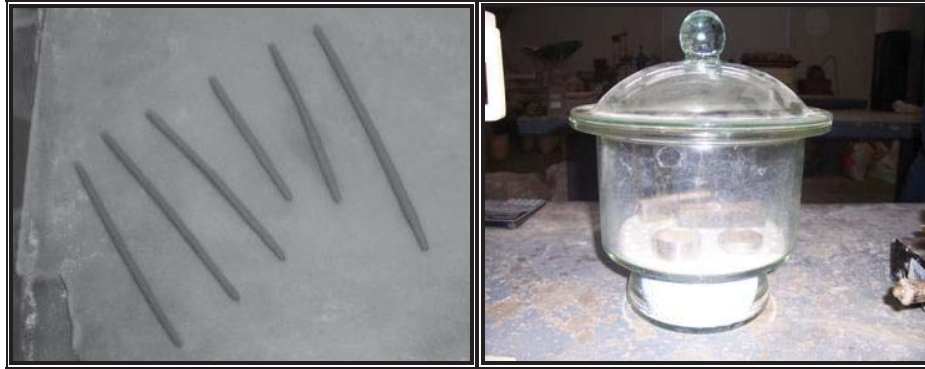
Figura 5.17)._Prueba de Limite Plástico y desecador de cristal con gel de sílice.
