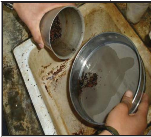
Figura 5.11). _Análisis del suelo fino por decantación.
