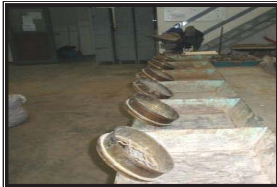
Figura 5.10)._Equipo necesario para determinar la distribución granulométrica en suelos gruesos.
