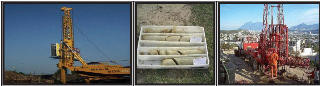
(Figura 5.6).-Equipo para perforación para muestreo profundo en suelos.
