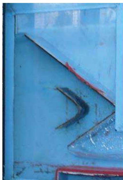
Variando el ángulo y posición del baffle 1 o mascara 1, además de la colocación del escalón en varias posiciones.
