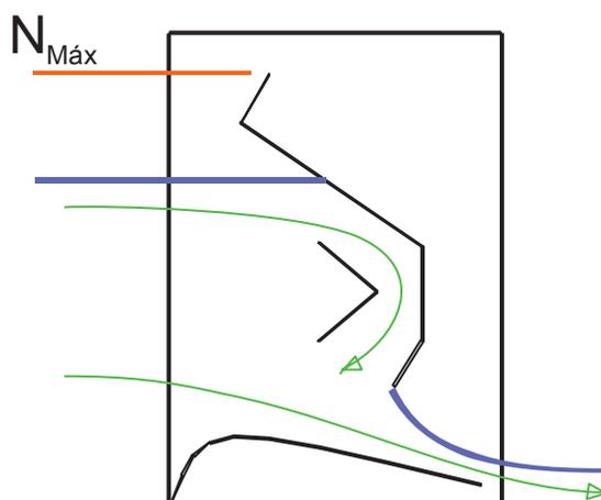
En la zona de tubo, existe sin embargo una altura máxima ideal de funcionamiento del módulo, y se define como aquella para la cual se entrega el 110% del gasto nominal de diseño. De esta forma, la diferencia de alturas entre el nivel para el cual se presenta el 90% del gasto nominal y el 110% del mismo, determina el rango de operación del módulo.
