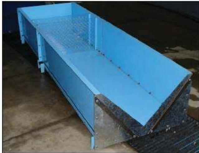
Fotografía V-4. Vertedor Triangular de pared delgada
