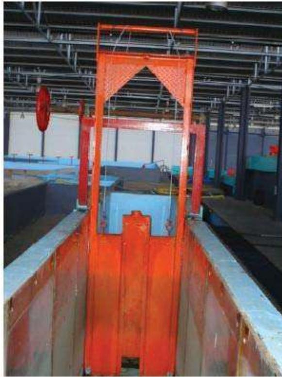
*Fotografía V-2. Compuerta Deslizante*
