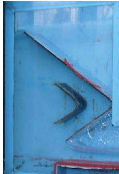
Con el escalón más atrás y el baffle 2 modificado el ángulo del baffle 1.
