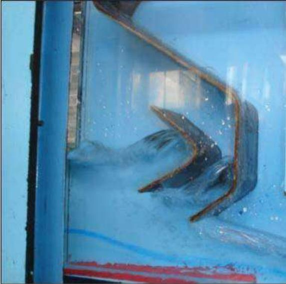
En los primeros ensayos, el trazador usado se colocó a la altura media de la salida que comprenden la parte inferior del bafle 1 con el escalón horizontal, mostrando que el flujo queda perfectamente establecido por la geometría que tiene el escalón haciéndose prácticamente paralelo a la pendiente cero del escalón.
