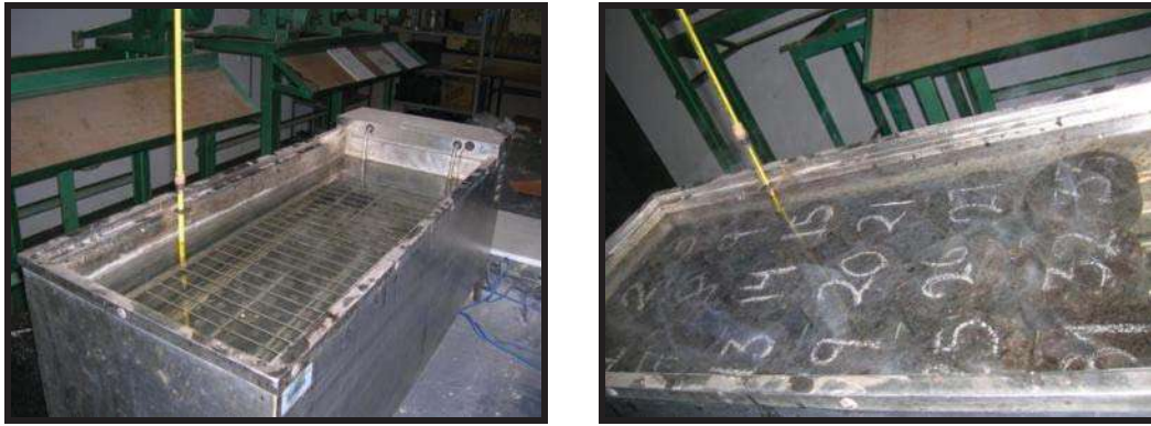
Fig. 7.7 Probetas en baño maría
