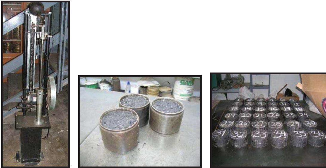
Fig. 6.7 Compactador y probetas terminadas
