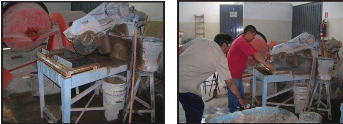
Fig. 7.9 Corte de las probetas
