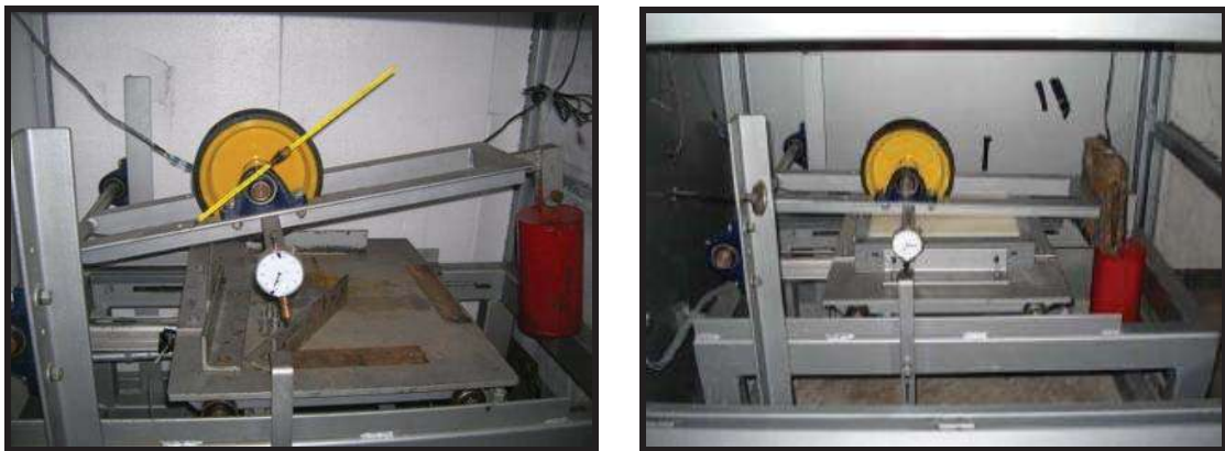
Fig. 6.4 Unidad de aplicación de carga.
