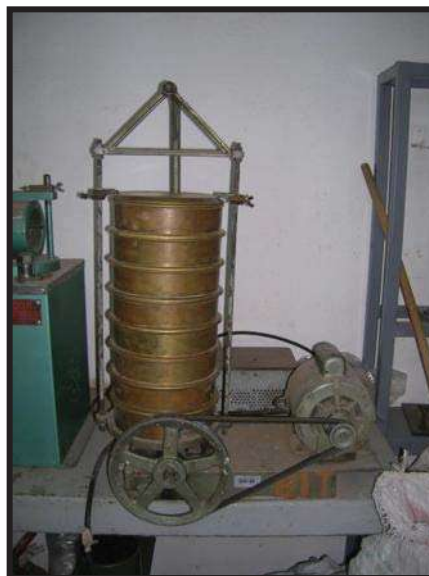
Fig. 7.2 Mallas y equipo mecánico de cribado
