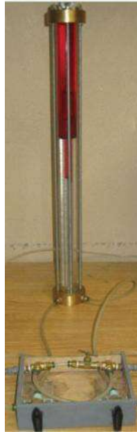
Figura III.14.- Sistema de Medición de Volumen.
