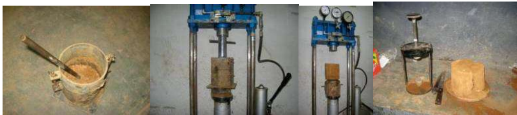
Figura IV.3.- Muestras Remoldeadas, moldeadas con prensa y labradas.
