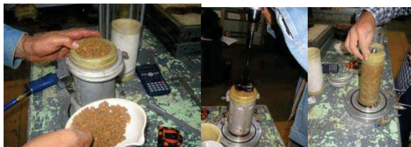
Figura IV.4.- Muestras Remoldeadas, moldeadas en el pedestal de la cámara con diámetro deseado.
