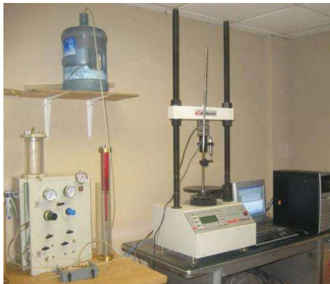
Figura III.19.- Equipo de pruebas de compresión triaxial con medición de presión de poro.
