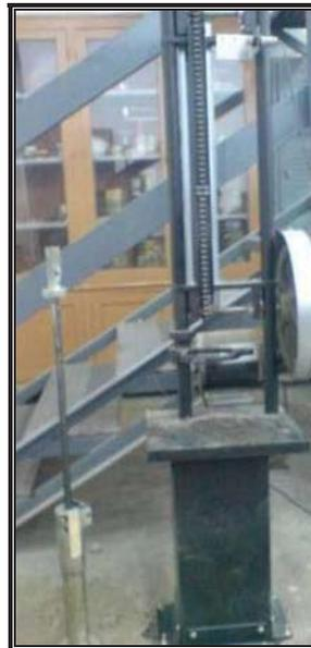
12. Se compacta la mezcla; Se le dan 50 golpes con el pizón en la máquina, después con mucha precaución se le da la vuelta al molde con la finalidad de que no se salga la mezcla del molde.
