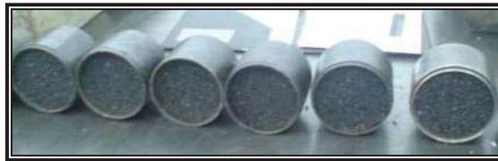
18. Por último se desmonta la probeta del molde con la ayuda de un pizón y un collarín, colocando el collarín debajo del molde y con el pizón, se golpea ligeramente la probeta hasta que esta salga del molde ver figura 5.9.
