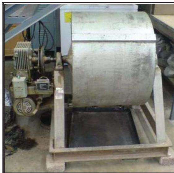
Una parte de la energía que se genera en cada impacto es absorbida por la deformación elástica del material, otra parte se elimina con las deformaciones plásticas y el resto que no pueden eliminar las probetas es la que causa la disgregación.
