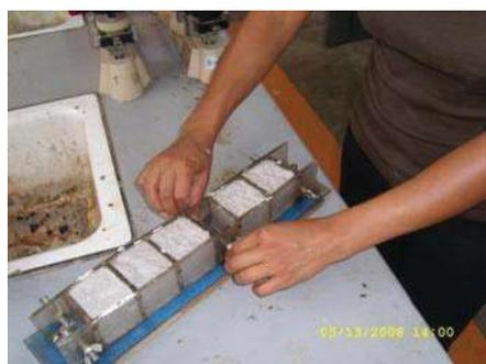
**Vigas de prueba.-** Espécimen de forma rectangular (4x4x16cms) con relación 1:4 necesaria para determinar la resistencia a la flexión de diferentes materiales [SCOOP, 1957].
