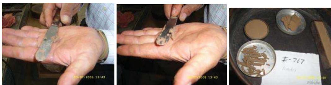
3. Se repite este procedimiento hasta que el rollito empiece a agrietarse o desmoronarse al estarlo agrietando.
