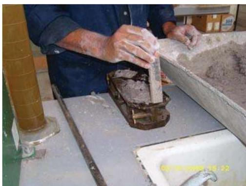
Almacenamiento.- Al terminar el modelado de los morteros elaborados, se dejan a la intemperie y al completarse el lapso de 20 a 24 horas, revisando que ya hayan fraguado. El almacenamiento de estos especímenes se hará en un lugar seco y libre de la humedad, y se procede a retirarlos de los moldes y permanecerán en tales condiciones hasta la edad de prueba, ya que los morteros de cal apagada no fragúan en presencia de humedad a diferencia de los morteros de cemento hidráulico.
